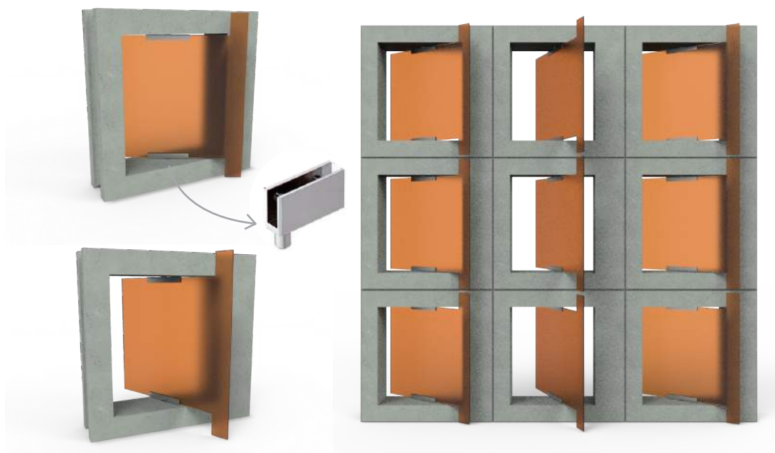
Figura 92 - Configuração do Cobogó Brise com o sistema de abertura/fechamento similar às janelas pivotantes, utilizando inclusive os itens de série para a instalação desse tipo de janela. Fonte: Elaboração própria.
