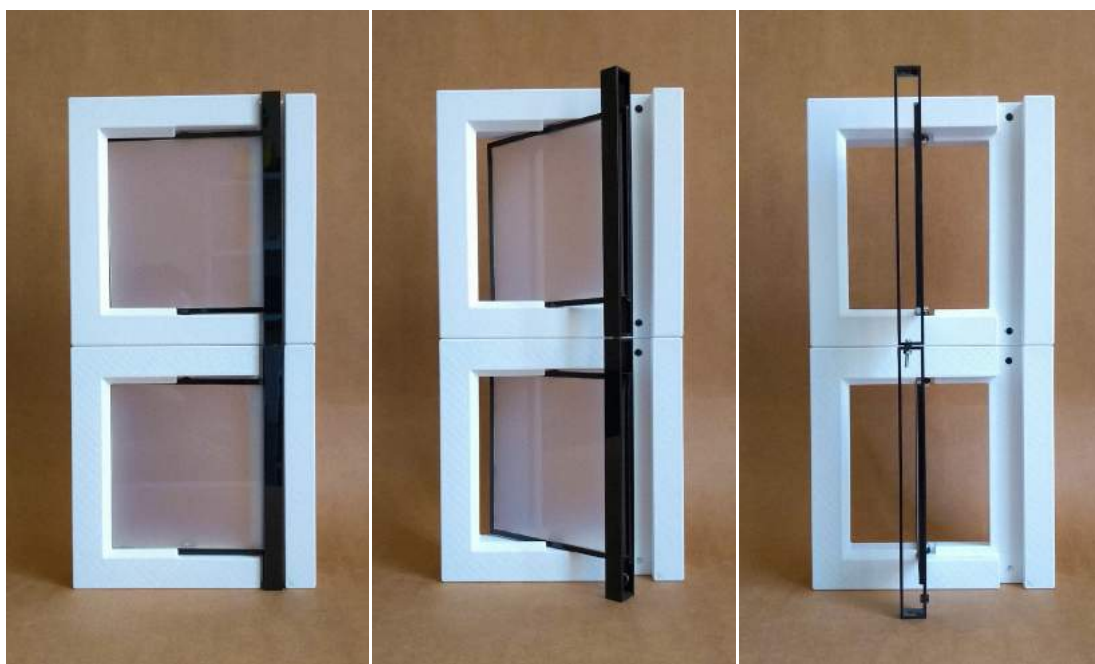
Figura 124 - Modelo final: Representação da abertura da parede de cobogós Brise, com o funcionamento integrado das peças de fechamento — vista frontal. Fonte: Elaboração própria.
