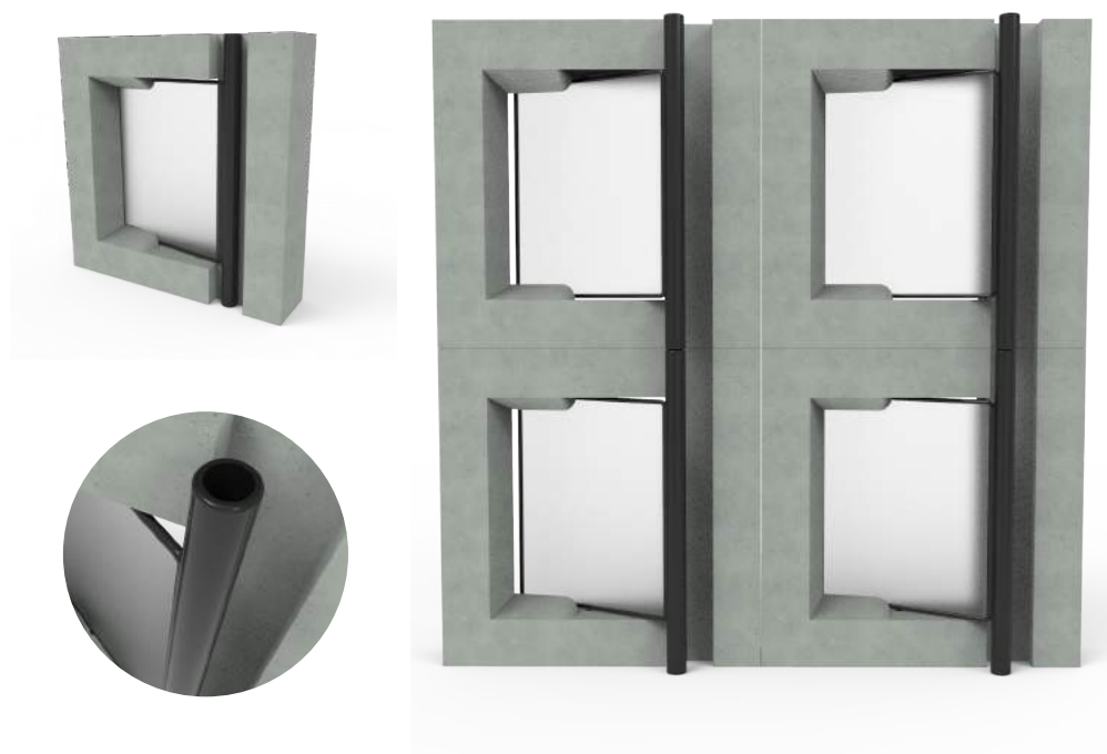
Figura 96 - Modelo digital do conjunto da placa de fechamento (puxador+moldura+batente) com formas mais robustas. Fonte: Elaboração própria.
