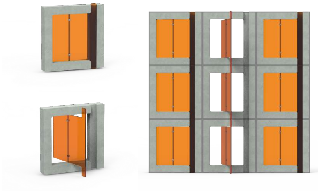
Figura 89 - Primeiro modelo digital do Cobogó Brise, aliando o sistema da Versão Brise com o estudo formal da área vazada. Fonte: Elaboração própria.
