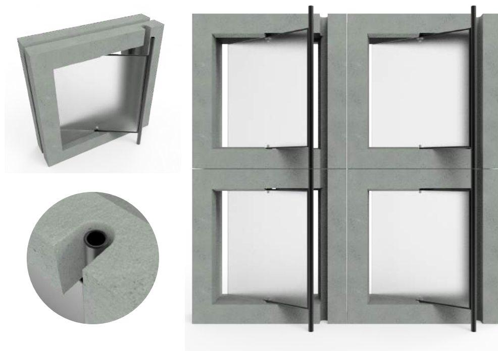
Figura 95 - Modelo digital do conjunto da placa de fechamento (puxador+moldura+batente) com formas mais delicadas. Fonte: Elaboração própria.
