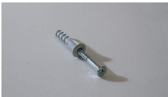
Figura 103 - Sistema de fixação da peça de fechamento, contendo bucha e parafuso LBP-8G da Trifixi . Fonte: elaboração própria.
