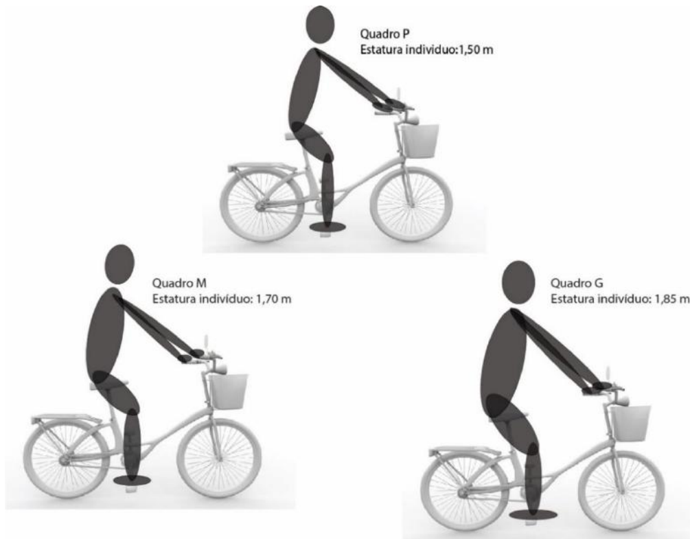
Figura 124: Teste bidimensional de adequação de percentis Fonte: do autor
