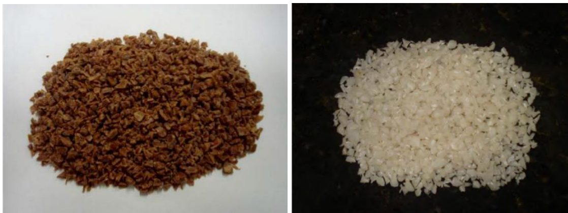
Figura 46: Comparação entre Compósito HDPE/pó de madeira e HDPE granulado Fonte: adaptado de (OLIVEIRA P.F. 2010)
