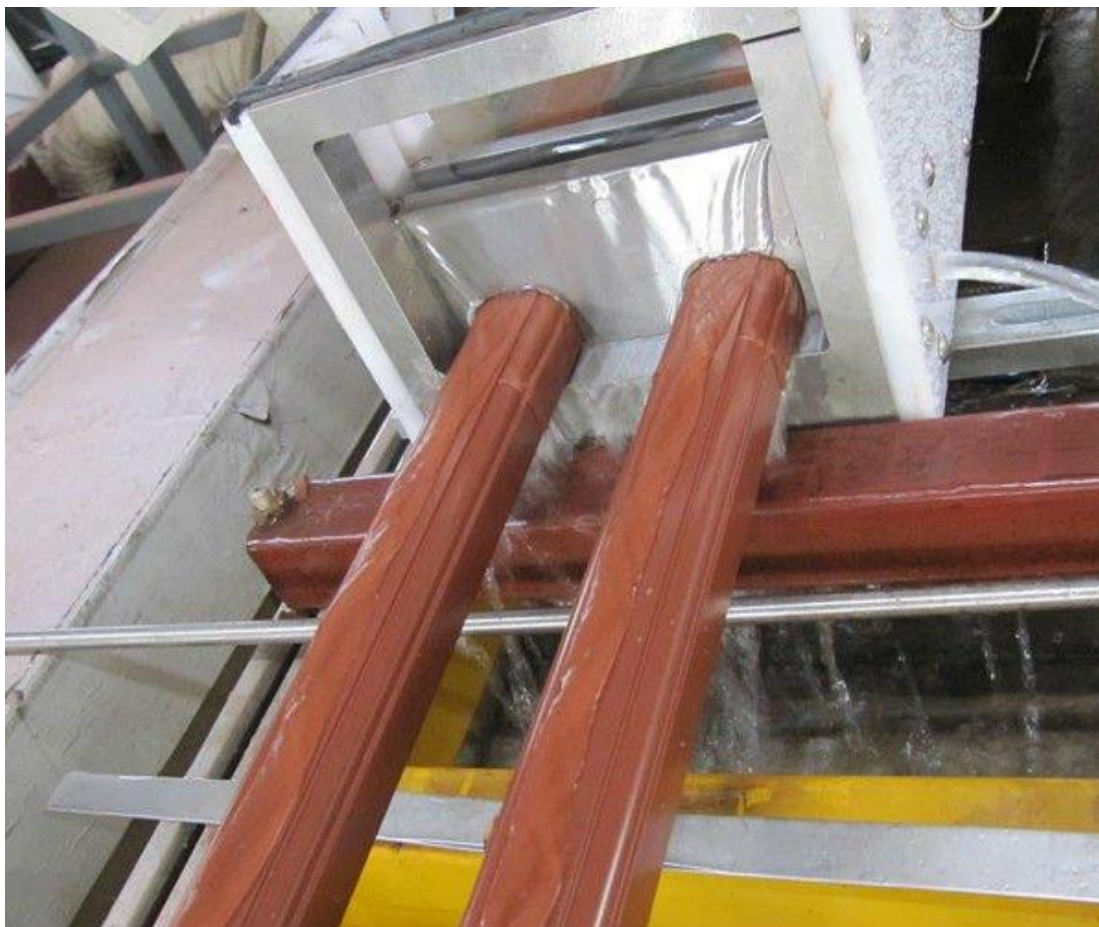
Figura 47: Extrusora processando perfil de madeira plástica.
