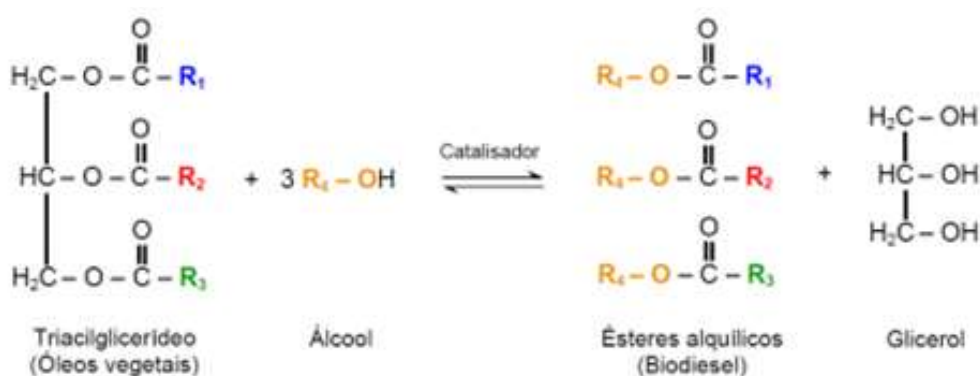
Figura 2.4 - Reação de transesterificação para produção de ésteres alquílicos (biodiesel) a partir de triacilglicerídeos (adaptado de SOUSA, 2013).
