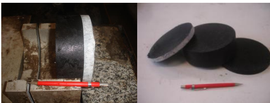
Figura 3.19: Corte topo e base do CP de MAF moldado no compactador giratório.
