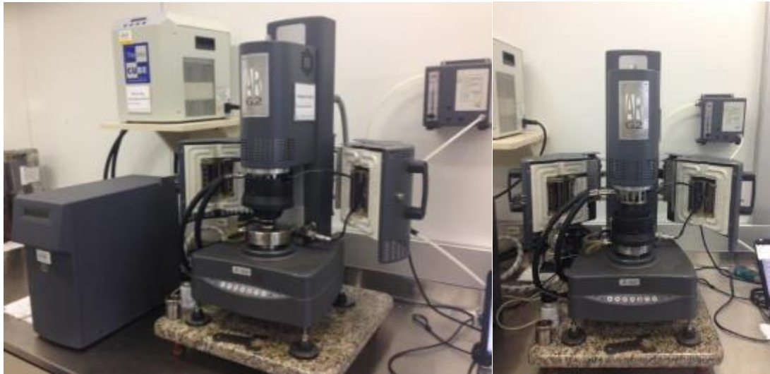
Figura 3.12: Reômetro de cisalhamento dinâmico – AR-G2 da TA Instruments do laboratório de ligantes asfálticos da Gerência de Produtos do CENPES.
