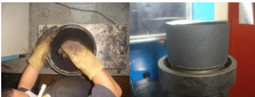
Figura 3.18: CP de MAF moldado no compactador giratório ( Superpave ).
