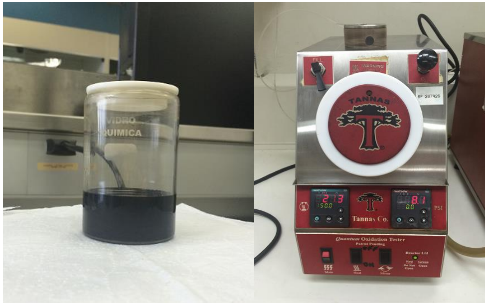
Figura 3.5: (A) Frasco de vidro com a amostra de CAP. (B) Equipamento RPVOT com ensaio adaptado para avaliação de ligantes asfálticos
