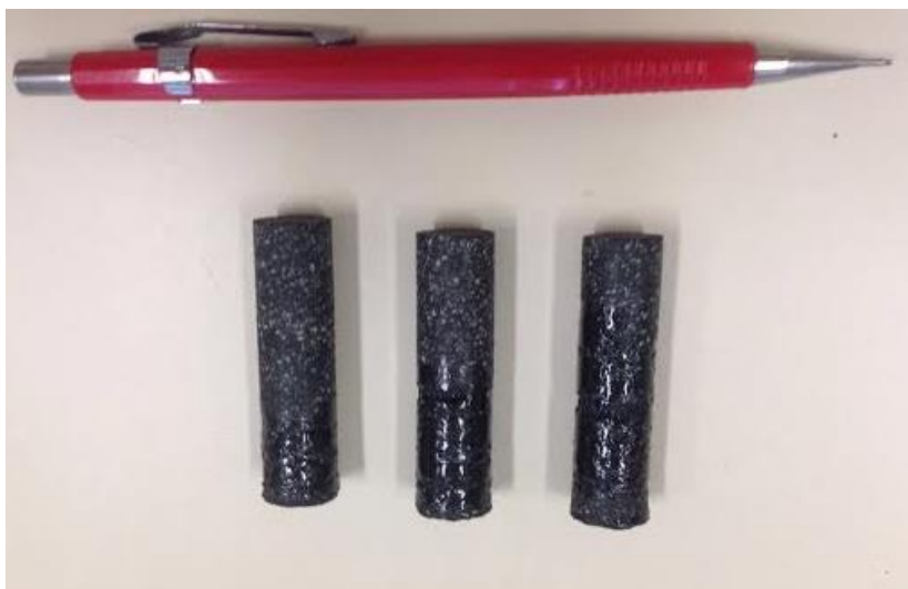
Figura 4.46: Amostras extraídas do CP de MAF com fíler de granito que apresentaram exsudação.
