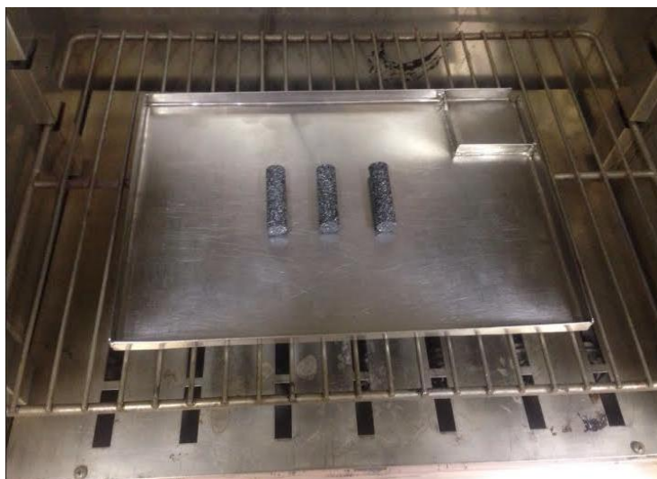
Figura 3.21: Amostras da MAF na posição horizontal para serem envelhecidas na Estufa.
