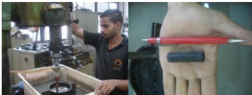
Figura 3.20: Extração das amostras da MAF para ensaios no DSR.
