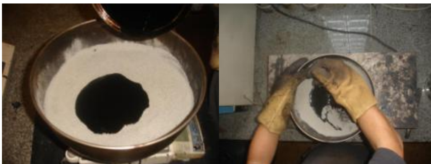
Figura 3.17: Mistura manual dos agregados e o CAP 50/70 A para esta pesquisa.
