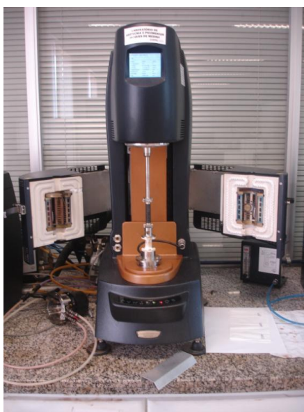
Figura 3.23: Reômetro do Laboratório de Geotecnia da COPPE utilizado para os ensaios de LAS no MAF.
