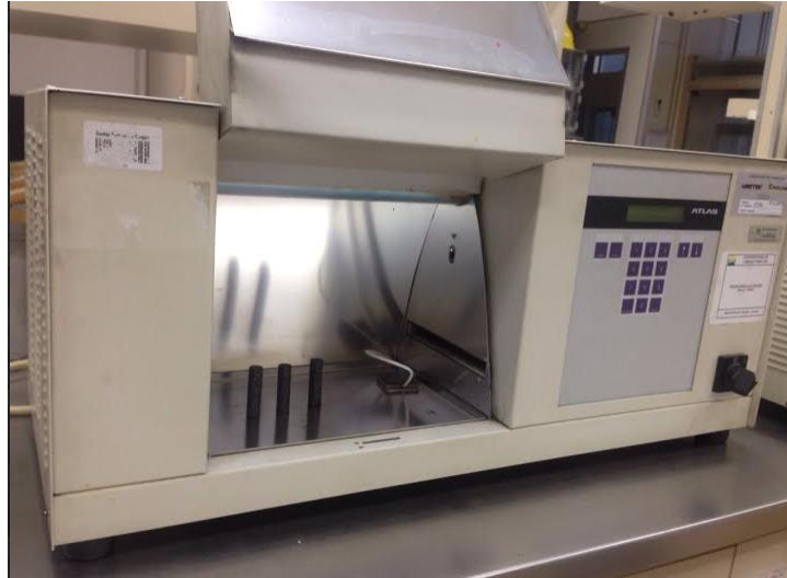
Figura 3.22: Amostras da MAF na posição vertical para serem envelhecidas no Suntest.
