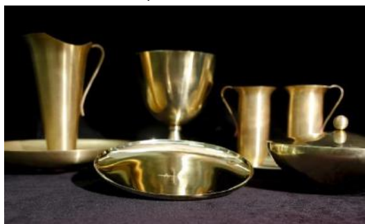
Figura 58: Vasos sagrados feitos em latão antes do banho de prata e ouro.
