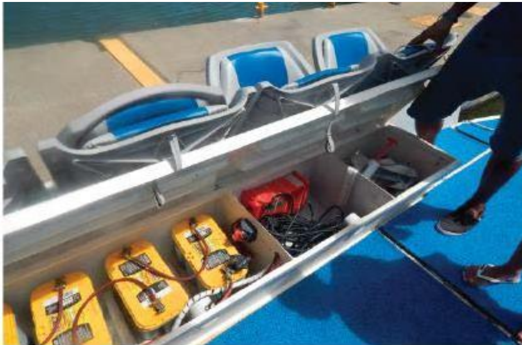
Imagem 29 - Localização da Baterias Embarcação Elétrica Fonte: Elaborada pelo Autor
