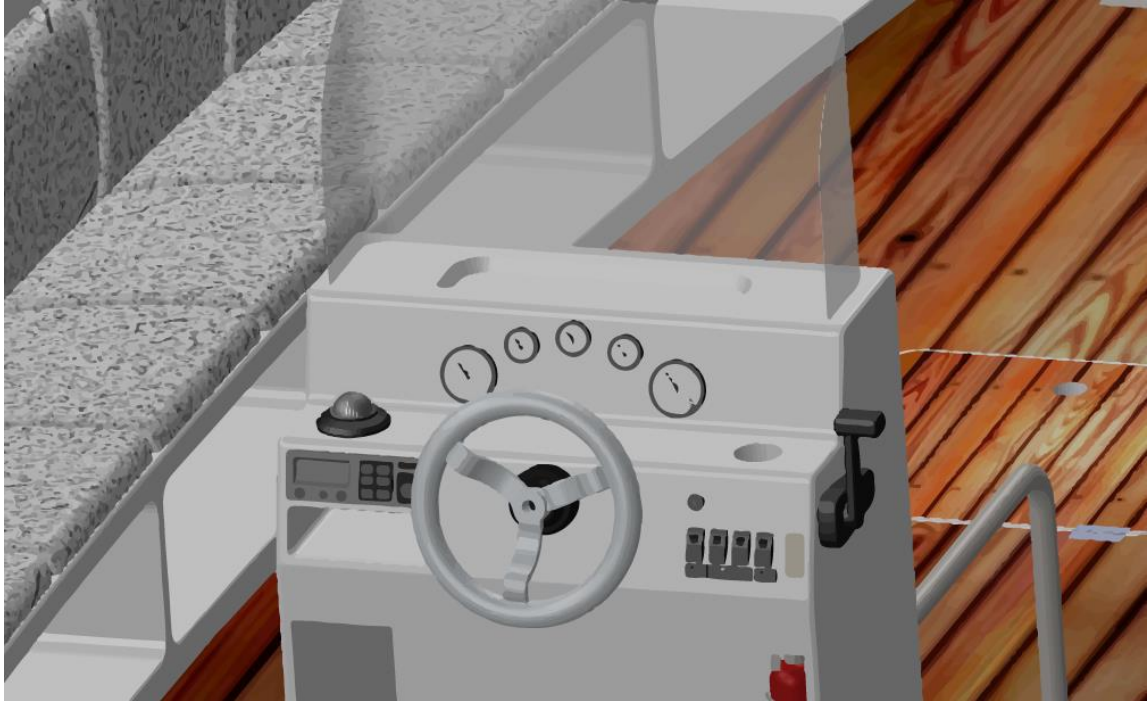
Imagem 137 - Organização dos Dispositivos no Console Fonte: Elaborada pelo Autor
