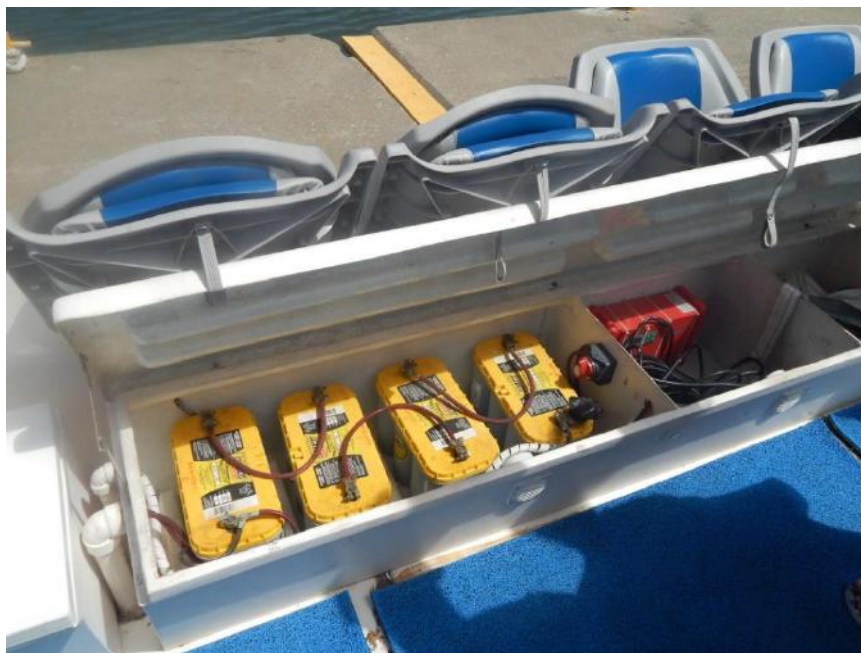
Imagem 19- Localização das Baterias Embarcação Elétrica Ampla Fonte: Elaborada pelo Autor
