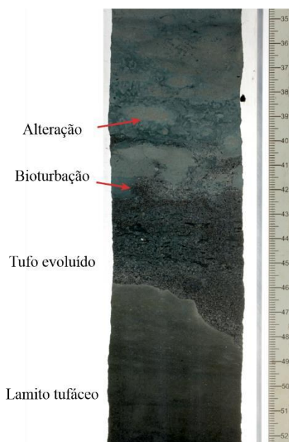
Figura 11. Scan de seção de testemunho no intervalo 350-U1437D-41R (811,22 a 811,49 m.a.f.o.) localizado na Figura 10, com tufo evoluído com contato inferior abrupto inclinado com lamito tufáceo e contato irregular bioturbado no topo. Nota-se a alteração de coloração esverdeada e intensa bioturbação. Modificado de Tamura et al. (2015b).
