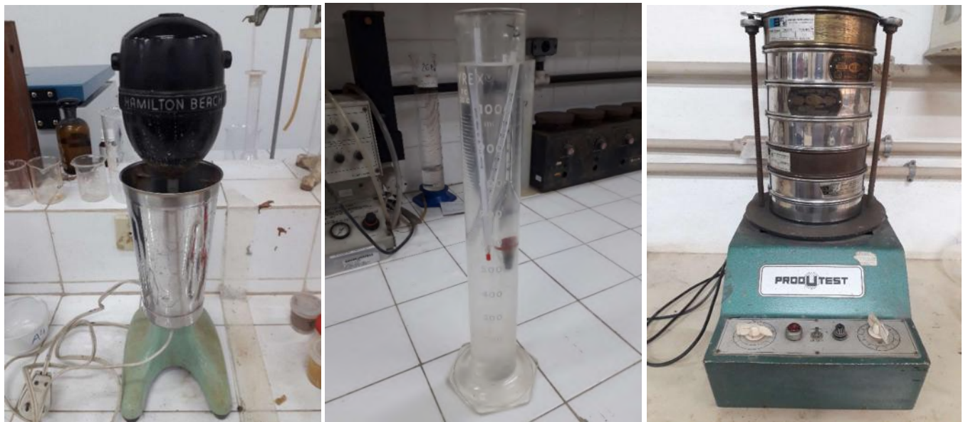
Figura 16 – Da esquerda para direita: dispersor, proveta e densímetro (usados no ensaio de sedimentação), conjunto de peneiras no agitador utilizados para o peneiramento.
