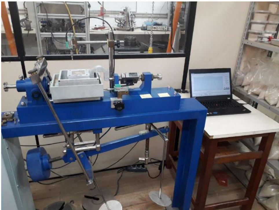
Figura 19 – Prensa de cisalhamento Contenco conectada ao software Pavitest Cisalhamento.
