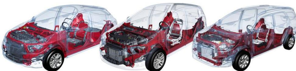
Figura 9: Da esquerda para direita, o Onix, o Sonic e a minivan Spin. A parte estrutural dos três modelos é igual (Fonte: [caradriverbrasil.uol.com.br](http://caradriverbrasil.uol.com.br))
