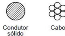
Figura 21: Tipos de condutores de metal (Fonte: Universidade Federal do Paraná)
