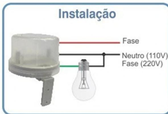
Figura 28: Esquema de instalação de uma fotocélula (Fonte: [www.supersafe.com.br](http://www.supersafe.com.br))
