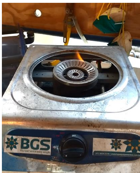
Figura 30: Fogão queimador simples, BGS (Fonte Acervo do autor)
