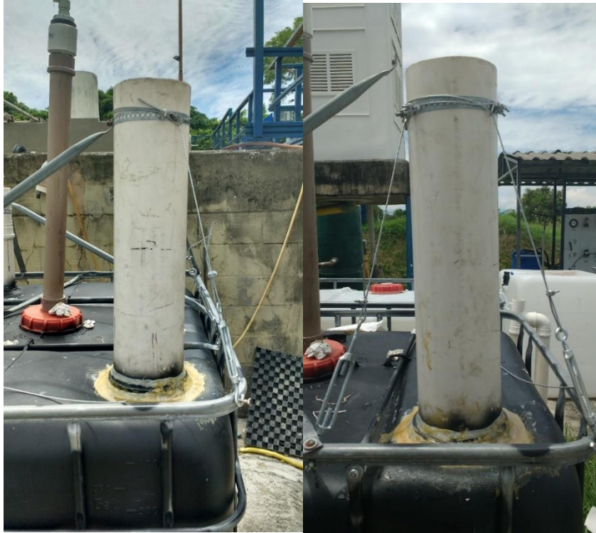
Figura 44: Fixação da parte superior do tubo de alimentação com tirantes tracionados (Fonte: Acervo do Autor)
