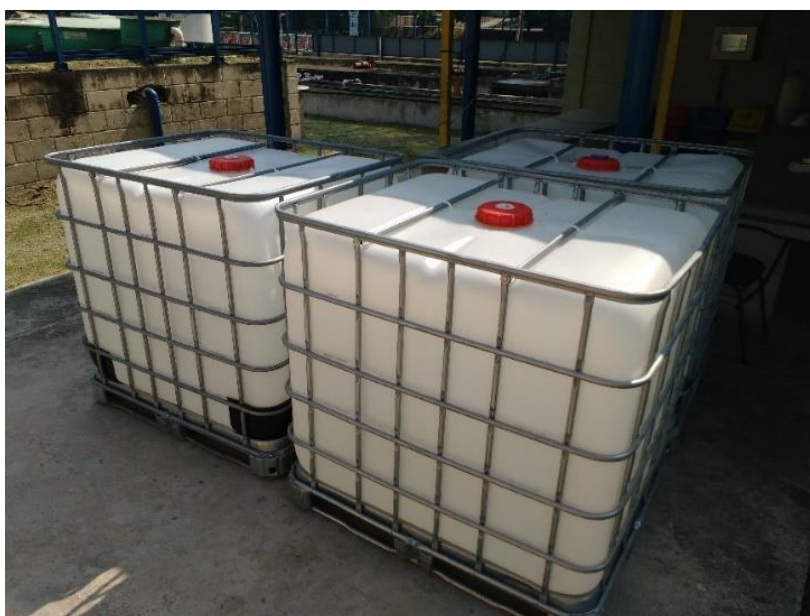
Figura 20: Tanques utilizados na fabricação do Digestor do projeto (Fonte: Acervo do autor)
