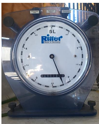
Figura 31: Medidor de volume de biogás produzido Ritter TG5-PVC-PVC (Fonte Acervo do autor)
