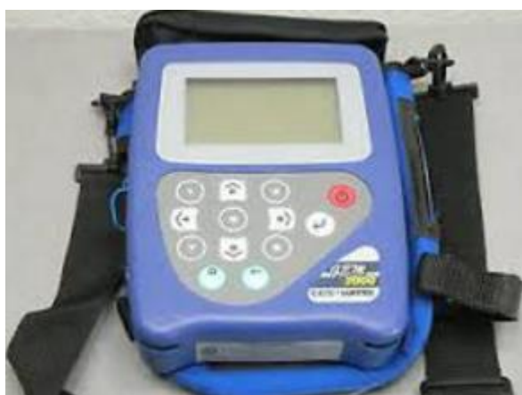
Figura 29: Leitor de composição da marca LANDTEC, modelo GEM2000 (Fonte Acervo do autor)
