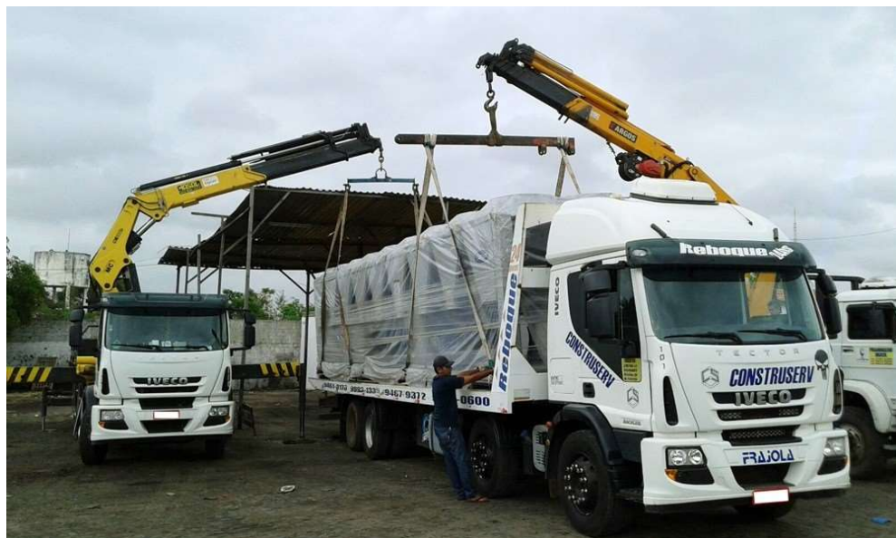
Figura 73 - Içamento de carga com tiras de nylon ou poliéster
