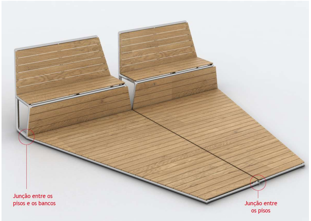
Figura 105 - Partes onde o módulo necessita de junções
