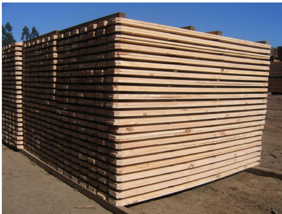
Figura 111 - Tábuas de eucalipto. Fonte: http://www.serf.com.br/site/components/com_joomgallery/img_originals/tbuas_4/eucalipto_20100331_1446400017.jpg
