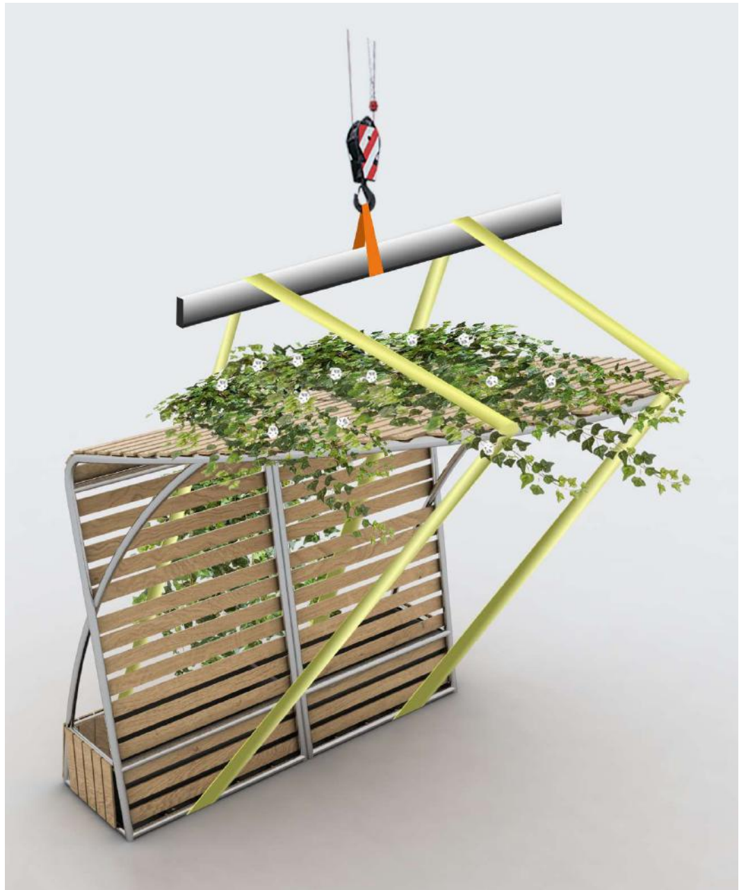
Figura 92 - Içamento do abrigo
