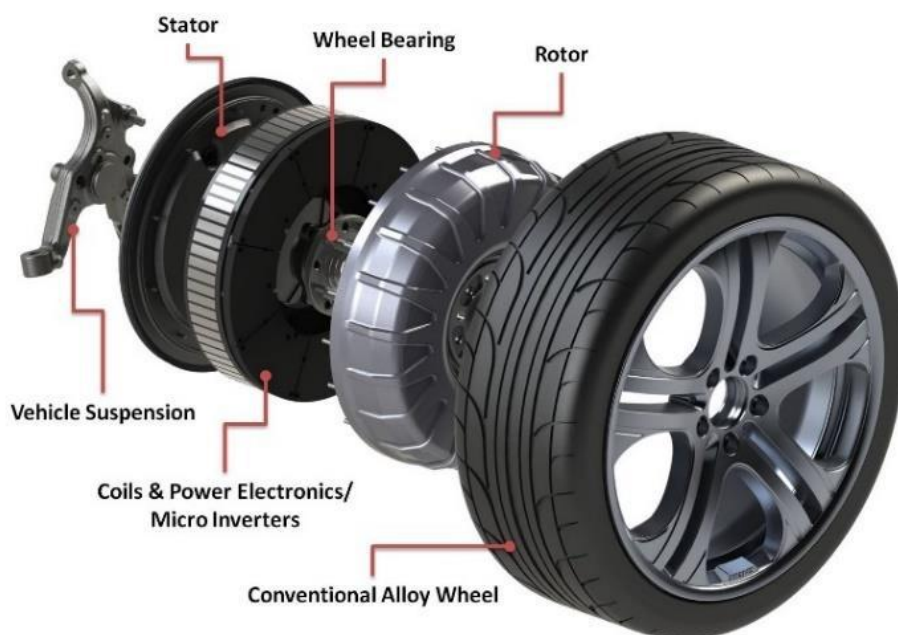
Figura 39 - Sistema de Motor dentro das rodas
