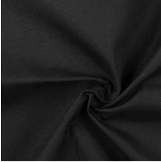
Figura 129 - Tecido Acrílico mais maleável que tecido com impermeabilizantes
