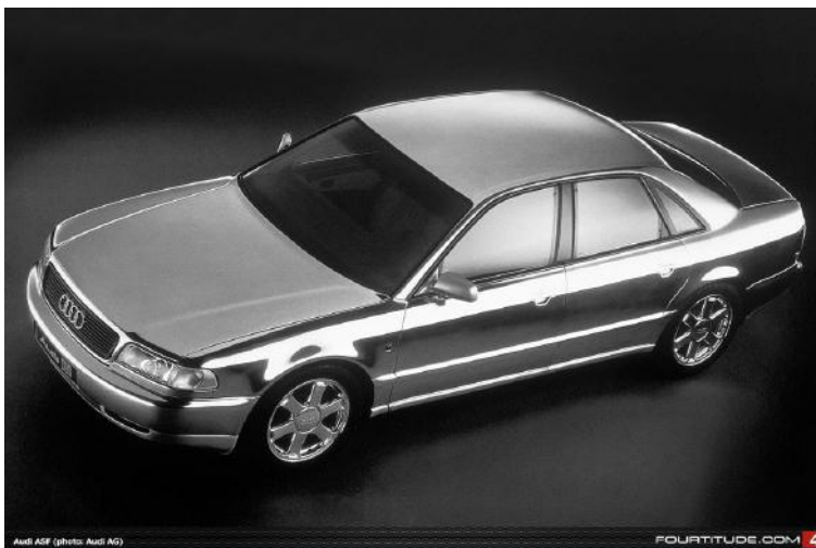
Figura 45 - Carroceria de Alumínio Audi A8 1994
