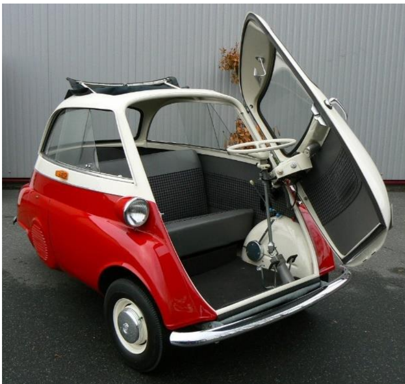
Figura 8 - A porta ao abrir trazia o volante para fora facilitando o acesso
