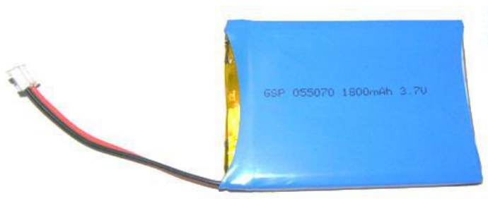
Figura 60 – Bateria de Íon de Lítio – Fonte: http://portuguese.tacbattery.com/
