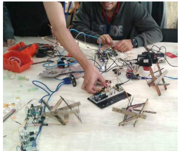
Figura 10 – Robôs tensegrities dançantes e Arduino.
