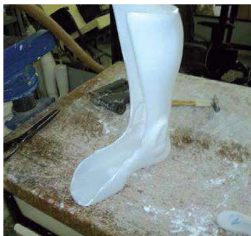
Figura 20: Órtese moldada em polipropileno.
