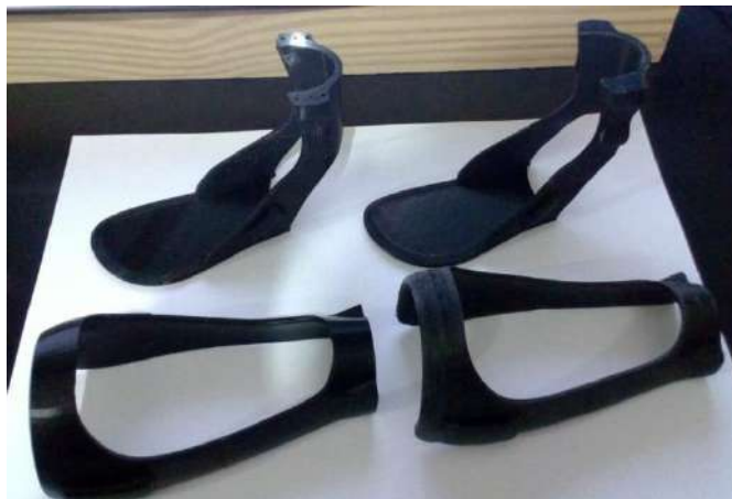
Figura 100: Modelo da órtese em escala, impresso em FDM.
