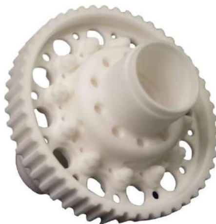
Figura 53: Peça impressa em SLS.
