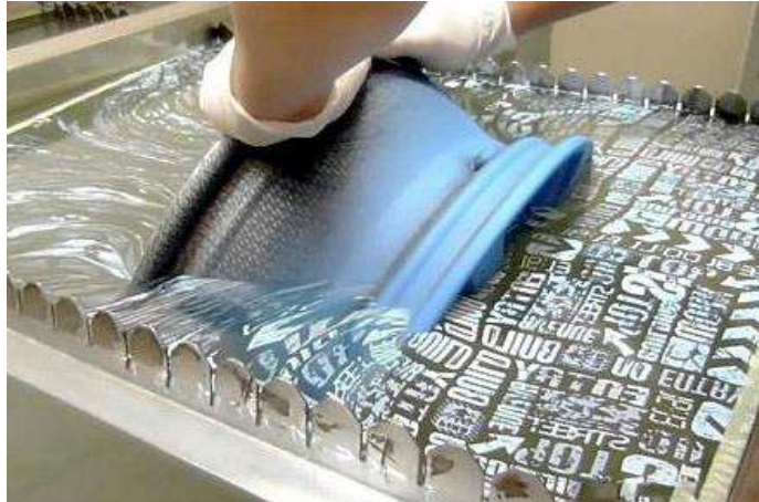
Figura 89: Processo de pintura por WTP.
