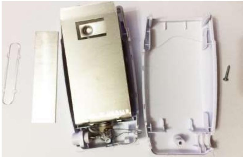
*Figura 65: Aquecedor de cera elétrico*
