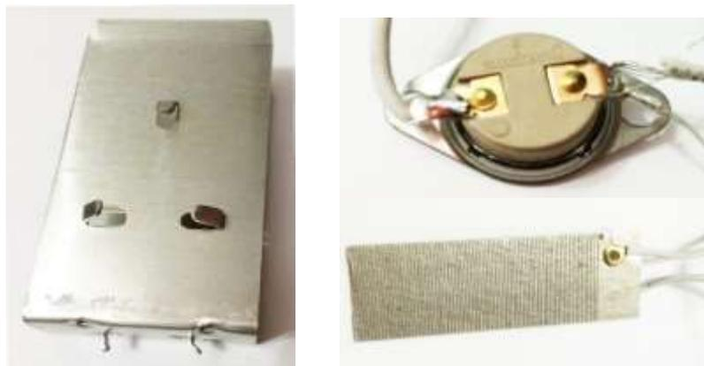
*Figura 66: Caixa metálica à esquerda e transistor e resistência à direita*
