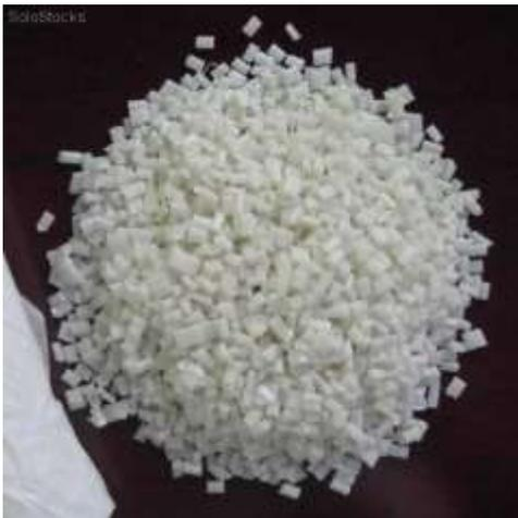
Figura 123: Plástico ABS granulado
