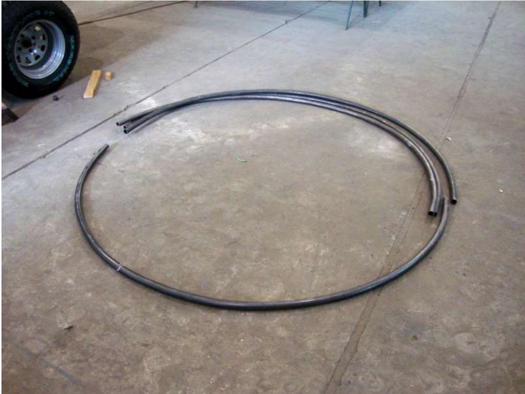
Figura 60: Resultado da dobra dos tubos
