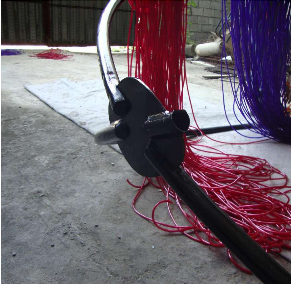
Figura 75: Ruptura do tubo superior da estrutura
