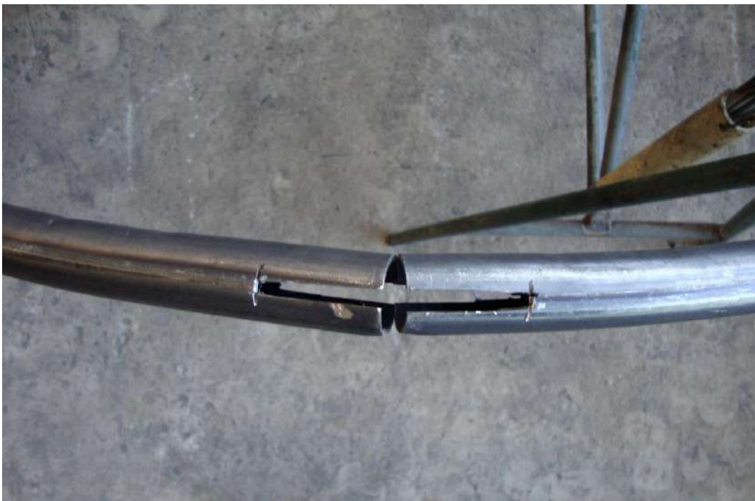
Figura 62: Corte para encaixe da chapa
