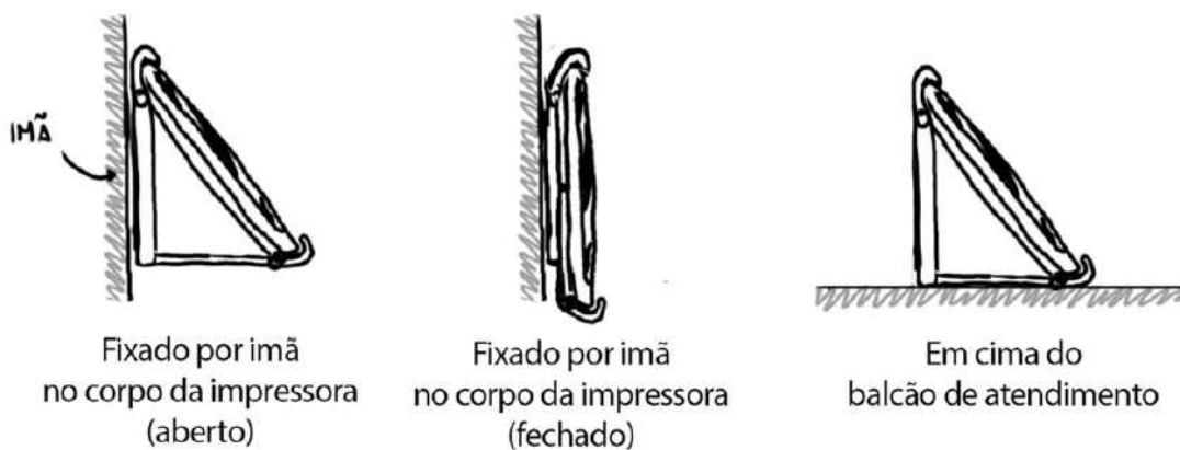
Figura 58: Possibilidades de uso fixado à impressora ou em cima do balcão de atendimento.
