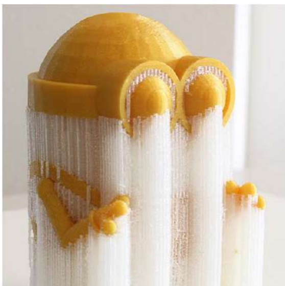
Figura 38: Peça (em amarelo) impressa com material de suporte (em branco).
