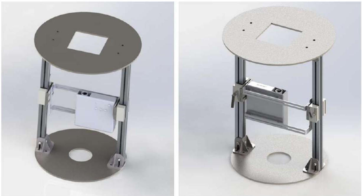
Figura 108: Sistema de posicionamento do projetor.
