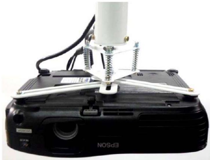
Figura 85: Suporte com projetor fixado.
