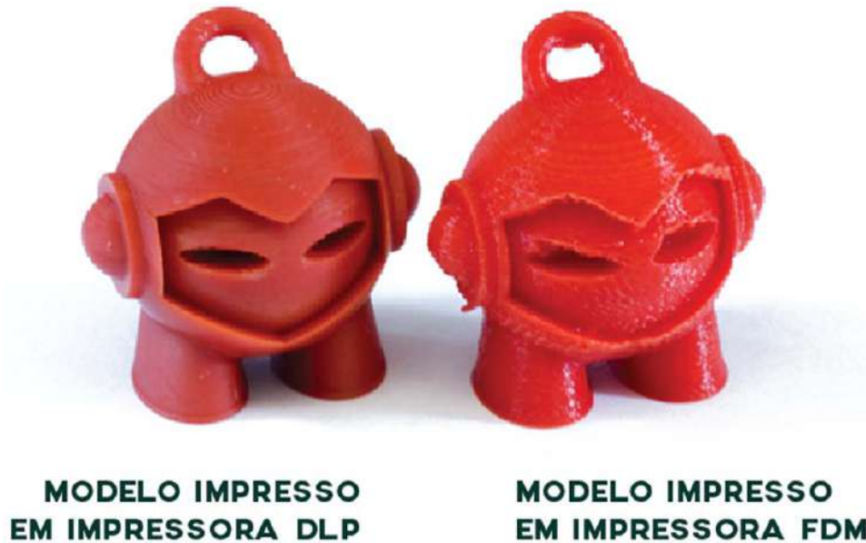
Figura 39: Comparativo entre produtos impressos por impressora DLP (à esquerda) e FDM (à direita).
