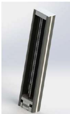
Figura 99: Sistema de movimentação vertical.
