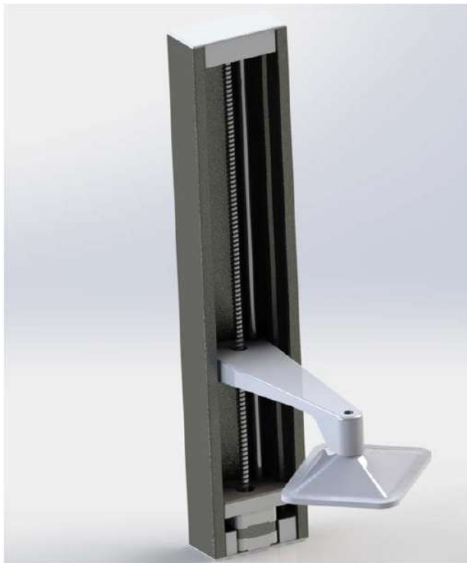
Figura 100: Elevador da plataforma
