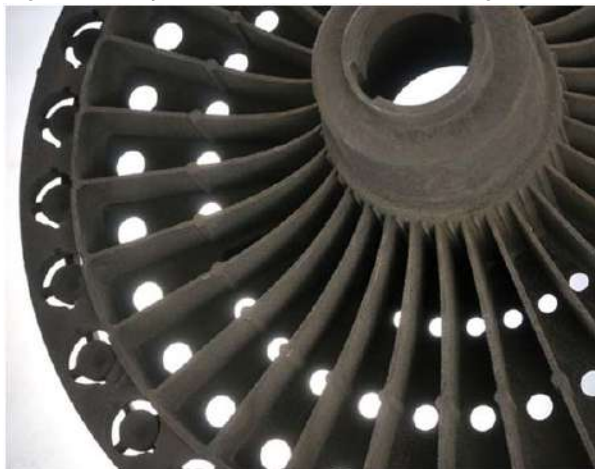
Figura 23: Peça fabricada através da tecnologia SLS.
