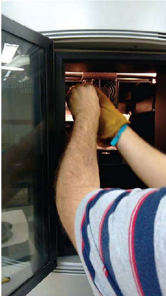
Figura 10: Acesso limitado à área de impressão e necessidade de uso de luva para proteção térmica.
