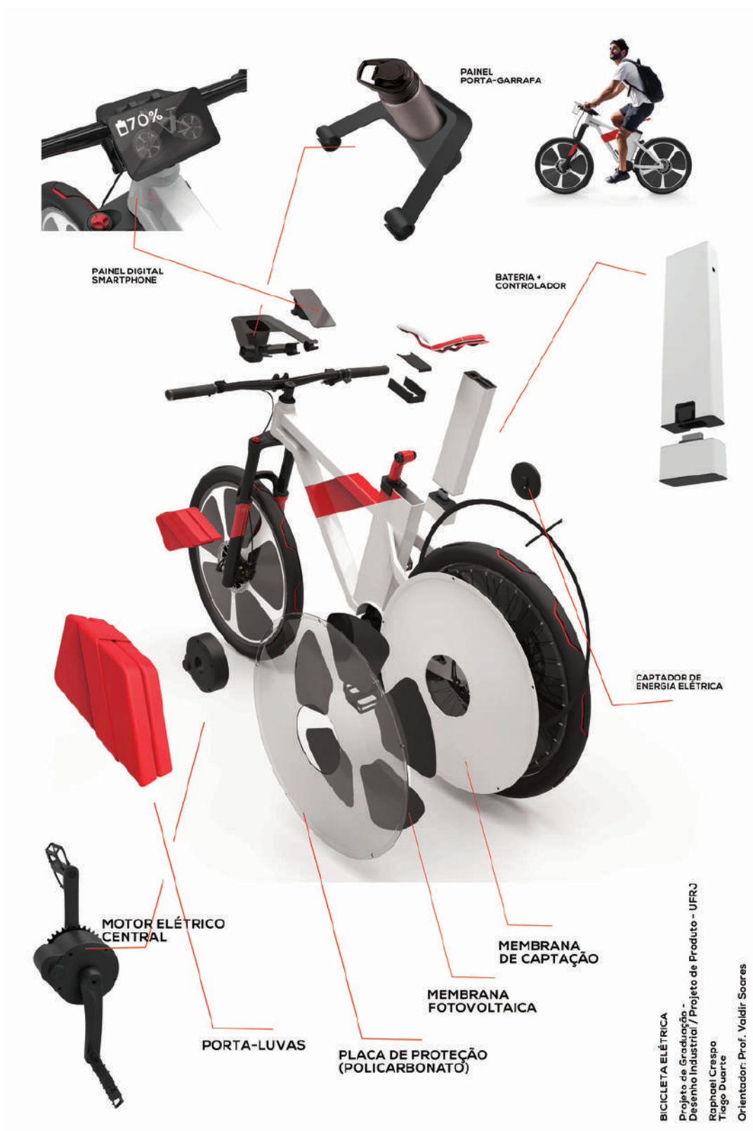
Figura 59 – Detalhamento e vista explodida.
