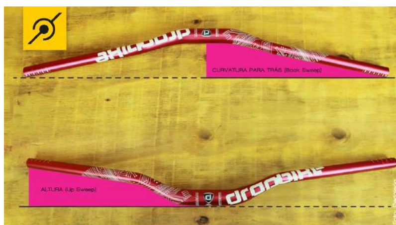
Figura 19 – Exemplos de guidão Up Sweep e Back Sweep.
