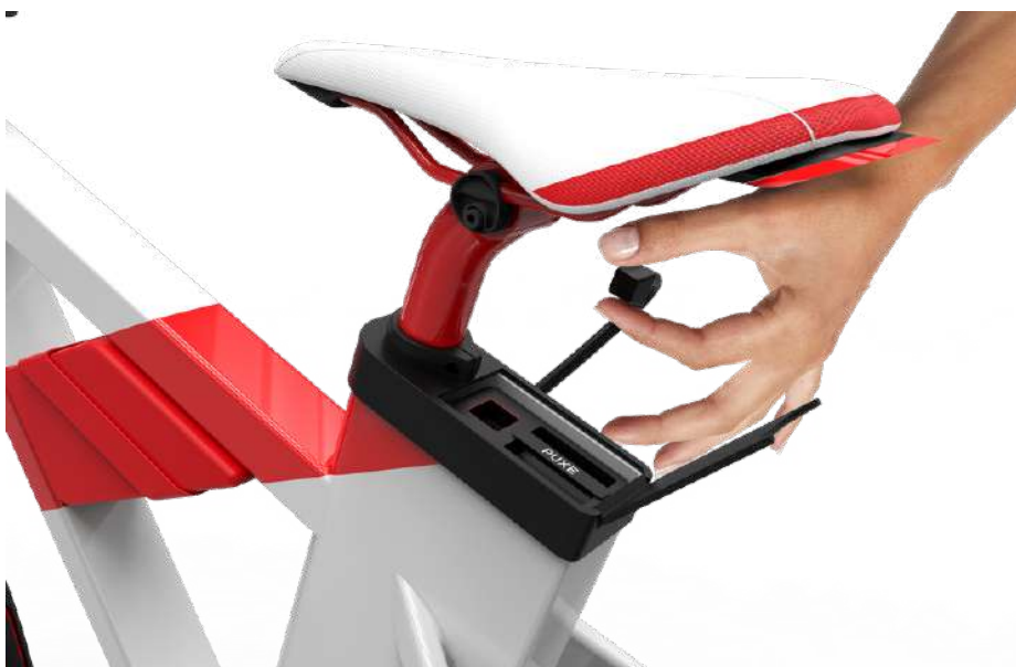
Figura 49 – Detalhe do acesso aos plugues de recarga de energia elétrica 2.
