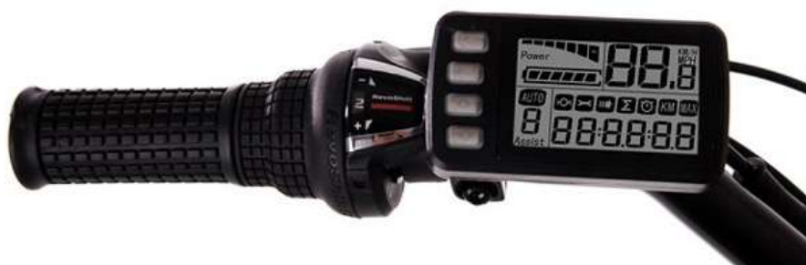
Figura 4 – Exemplo de acelerador localizado no punho esquerdo do guidão.
