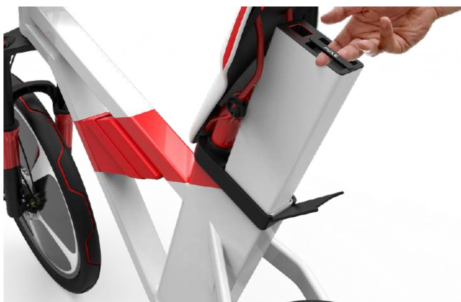
Figura 51 – Retirada da Bateria junto com o controlador 1.
