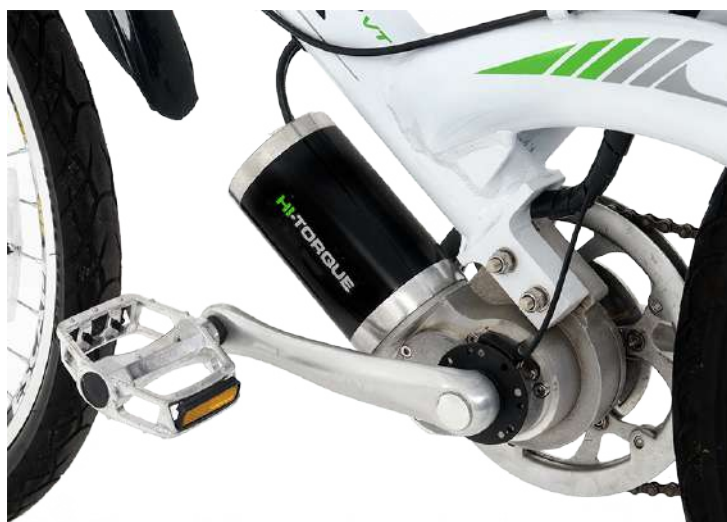
Figura 2 – Exemplo de motor alocado na pedivela.
