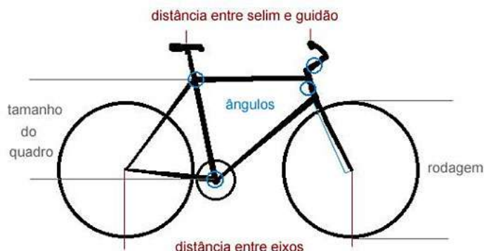
Figura 26 – Esquema ilustrativo das proporções de uma bicicleta.
