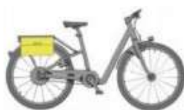
Figura 7 – Exemplos de alocação de bateria.
