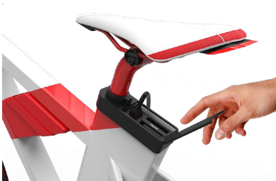
Figura 50 – Detalhe do acesso aos plugues de recarga de energia elétrica 3.
