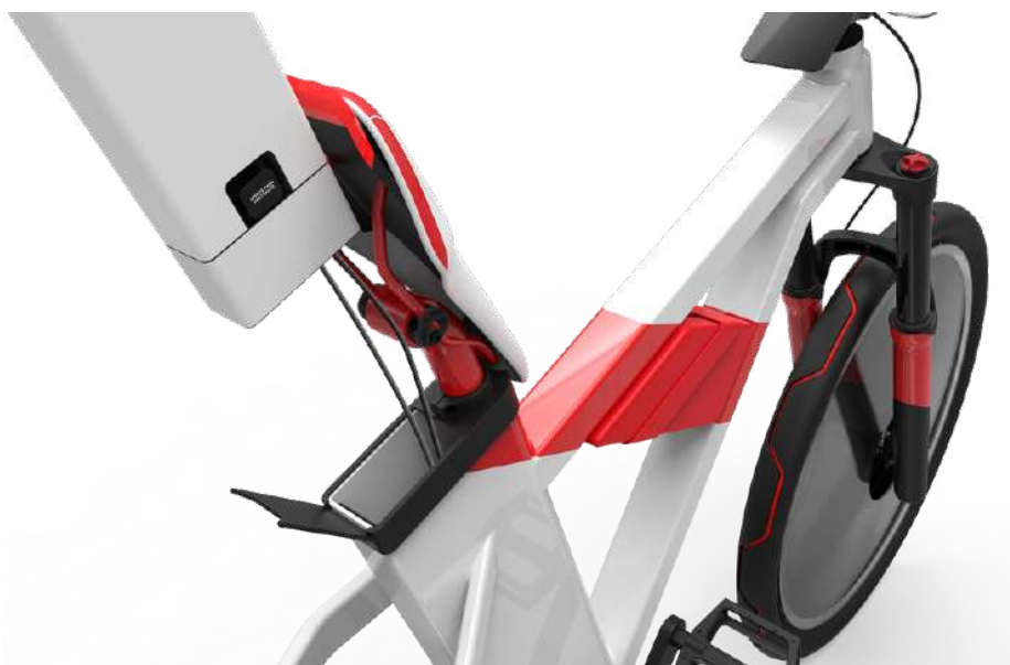
Figura 52 – Retirada da Bateria junto com o controlador 2.
