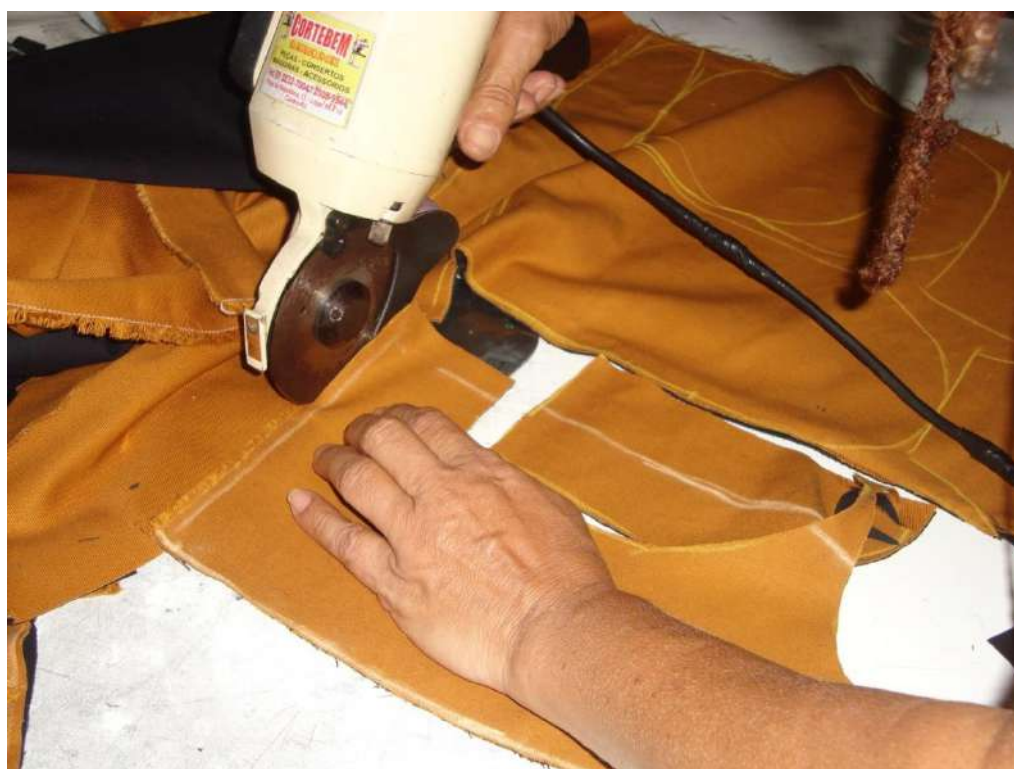
Figura 88: Corte com máquina do forro
