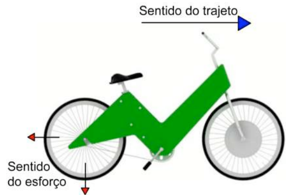
Figura IV.50 – Esforço sobre a roda traseira
