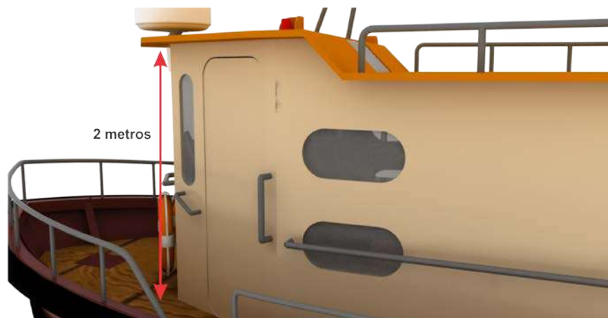
Fig. 29: Vista lateral com o detalhe da altura do teto da casaria na área da cabine. (Gouveia, 2009)
