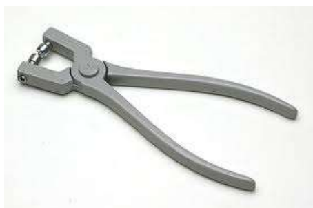
Fig. 102: Alicates para fixação dos botões de pressão de aço inox na rede. ( Google imagens, 2011 )
