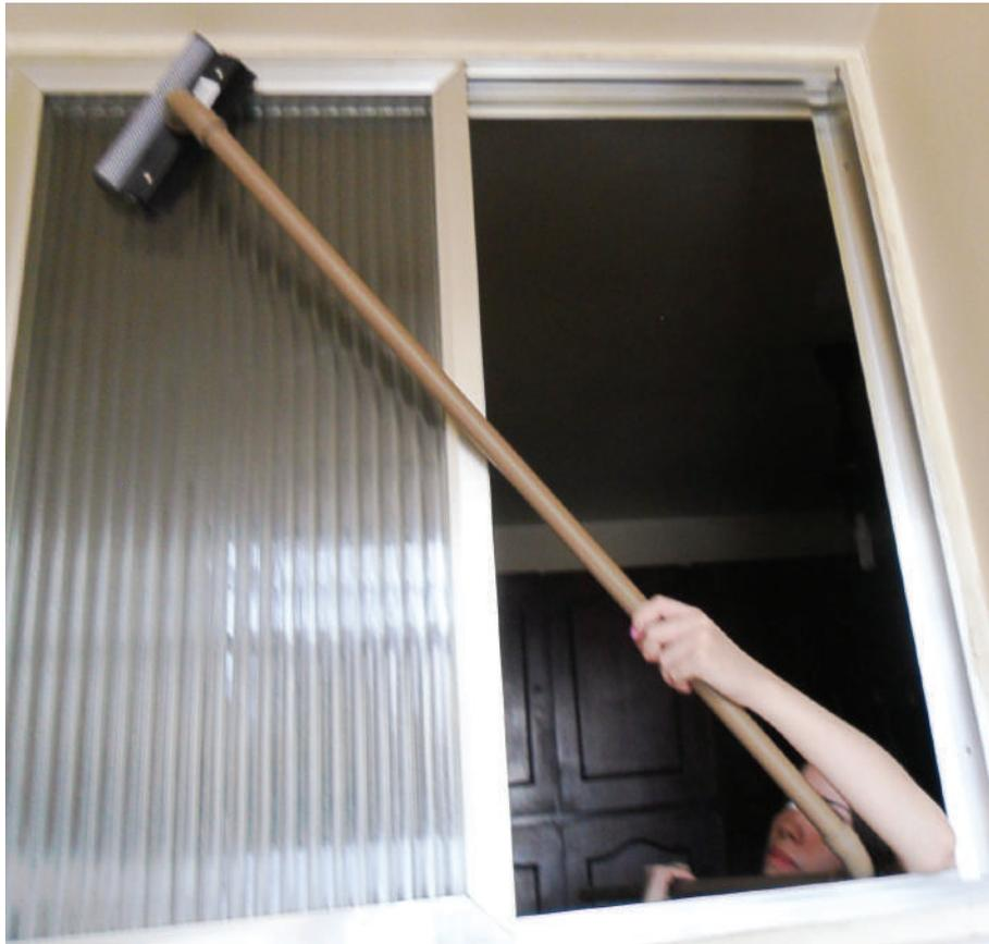
Figura 75: Simulação com um cabo de 96 e 98cm para entender como seria o funcionamento de um rodo com essa configuração.
