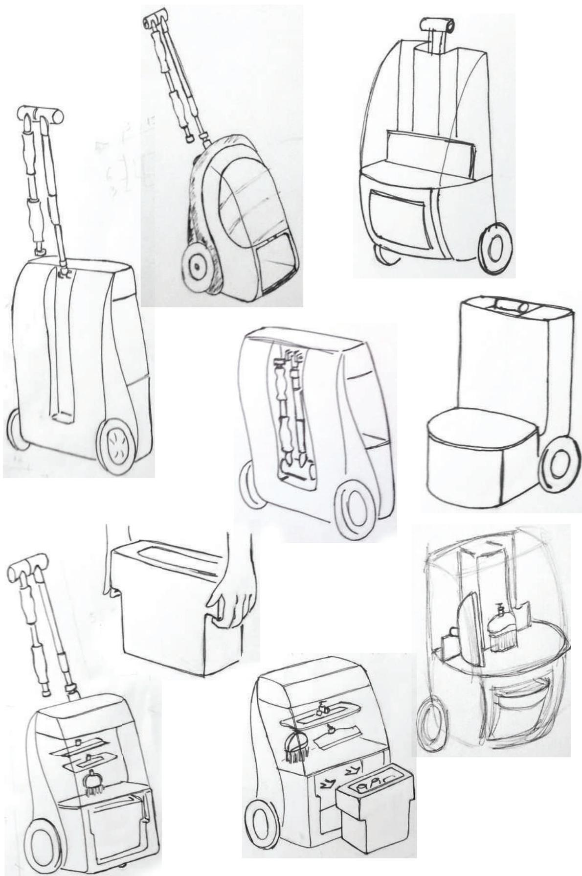
Figura 98: Roughs do carrinho baseados em aspiradores de pó na vertical.
