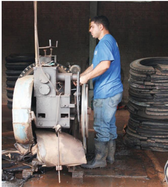
Figura 45: Processo de beneficiamento do pneu fatiado da Laminação Paraná. (Fonte: <http://recapagem-moreira.com.br/reciclados.html>)
