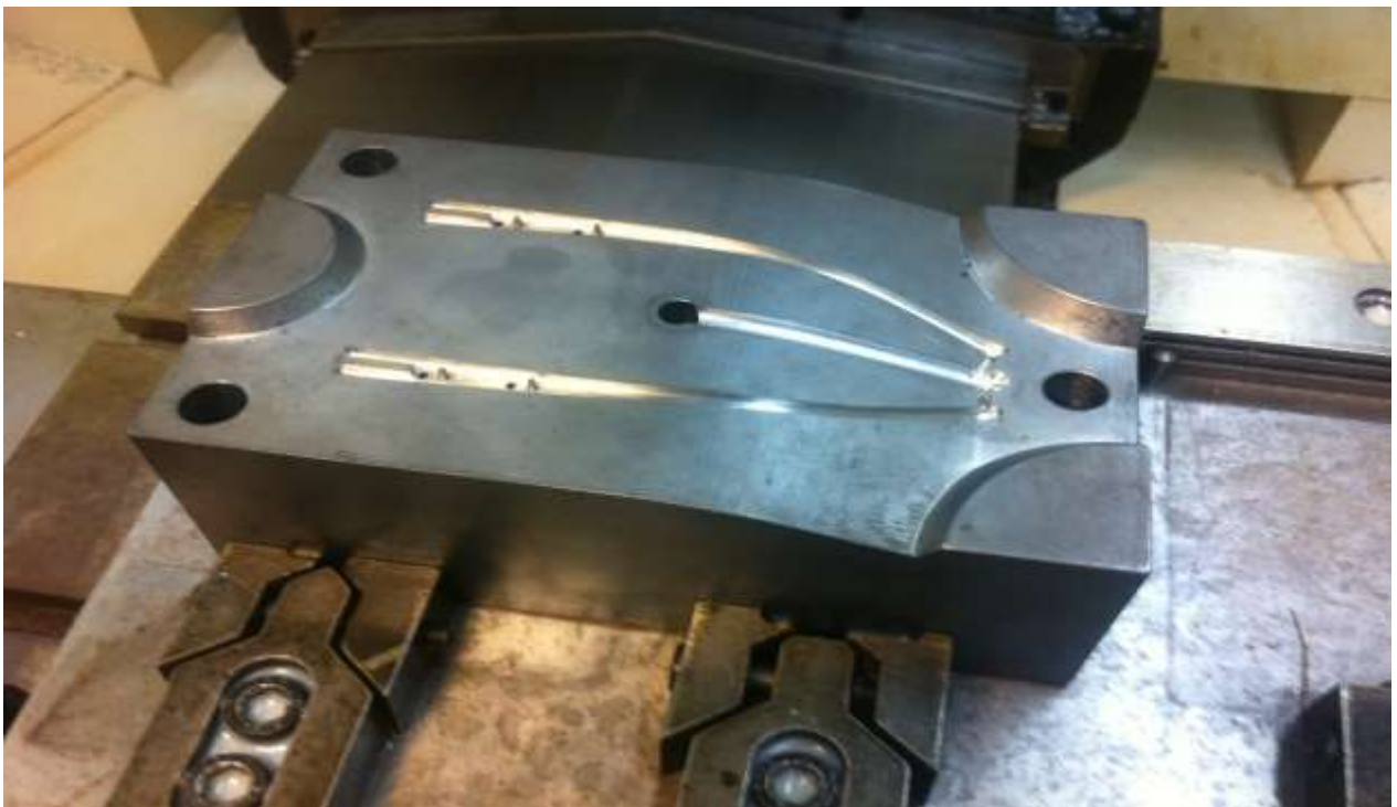
Figura 52. Molde injetor finalizado / Fonte: Yasser Regis
