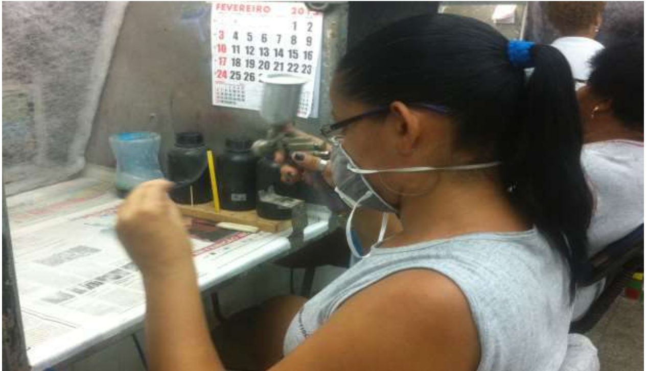
Figura 65. Funcionária utilizando pistola de tinta para a pintura / Foto: Yasser Regis
