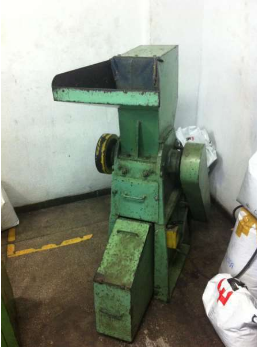
Figura 44. Moinho existente na fábrica /Foto: Yasser Regis
