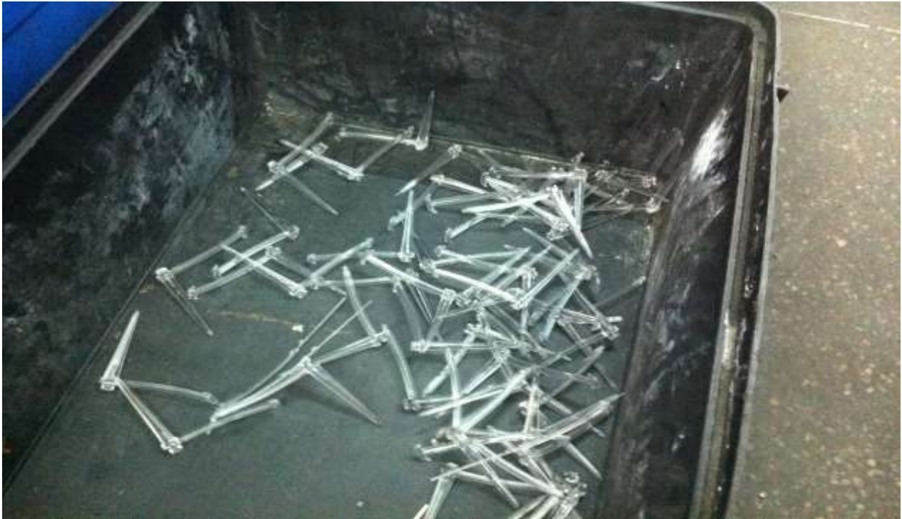
Figura 42. Canais injetores descartados / Foto: Yasser Regis
