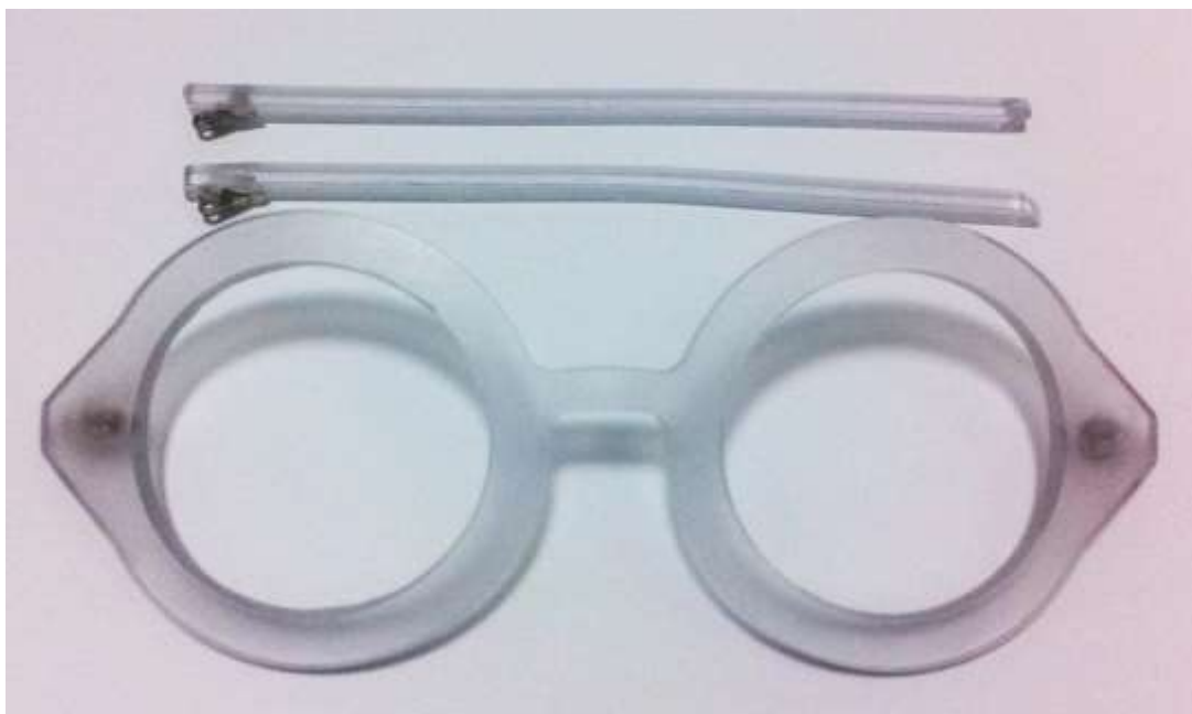
Figura 171. Modelo Le Corbusier após os processos de vibroacabamento, curvatura e fixação da charneira / Foto: Yasser Regis
