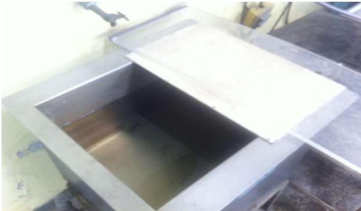
Figura 170. Tanque de água quente utilizado para dar curvatura manual no modelo / Foto: Yasser Regis
