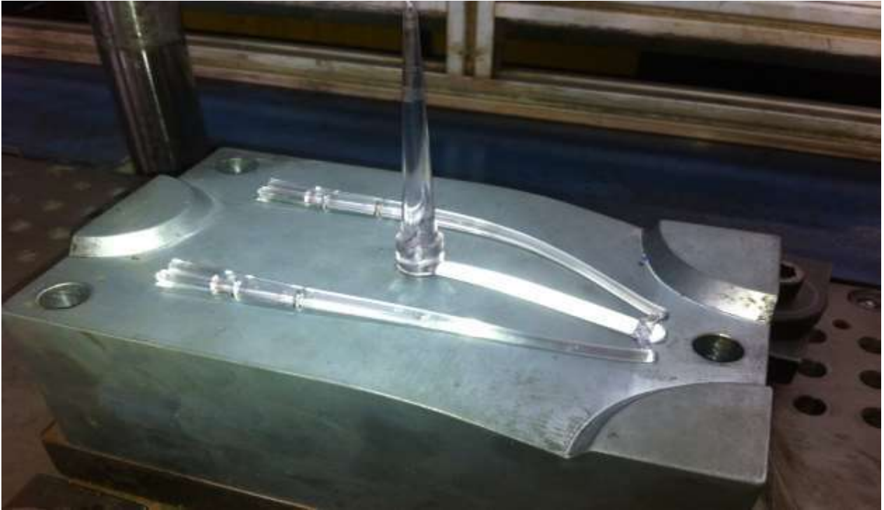
Figura 57. Término do processo de injeção / Foto: Yasser Regis
