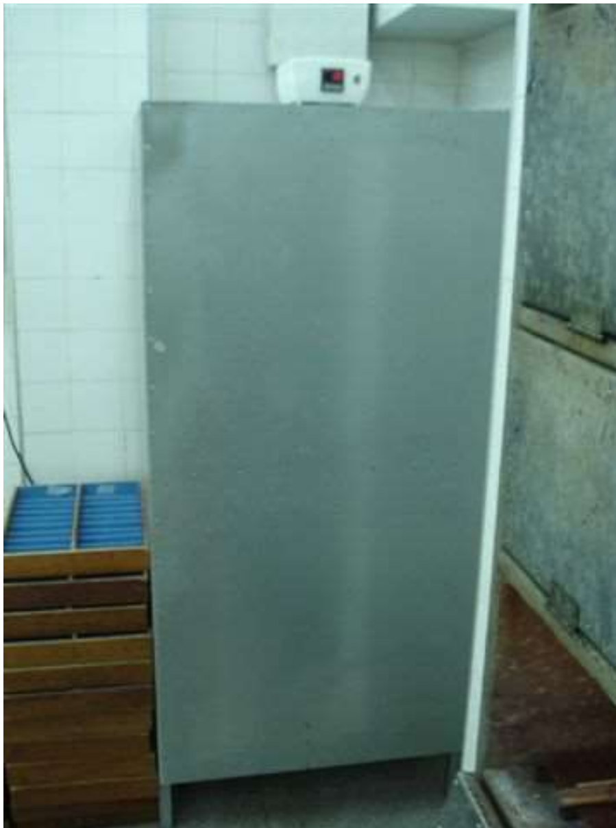
Figura 67. Estufa de cura / Foto: Yasser Regis
