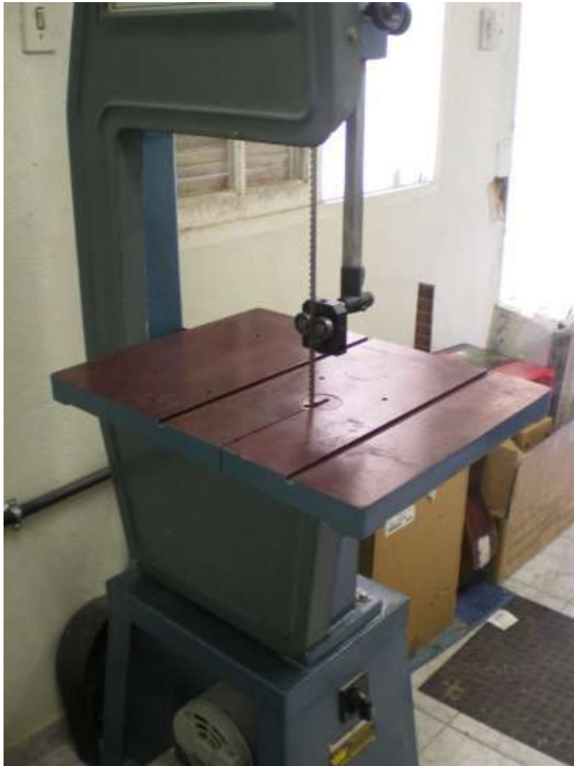
Figura 168. Serra de fita utilizada no processo de fabricação do modelo físico / Foto: Yasser Regis
