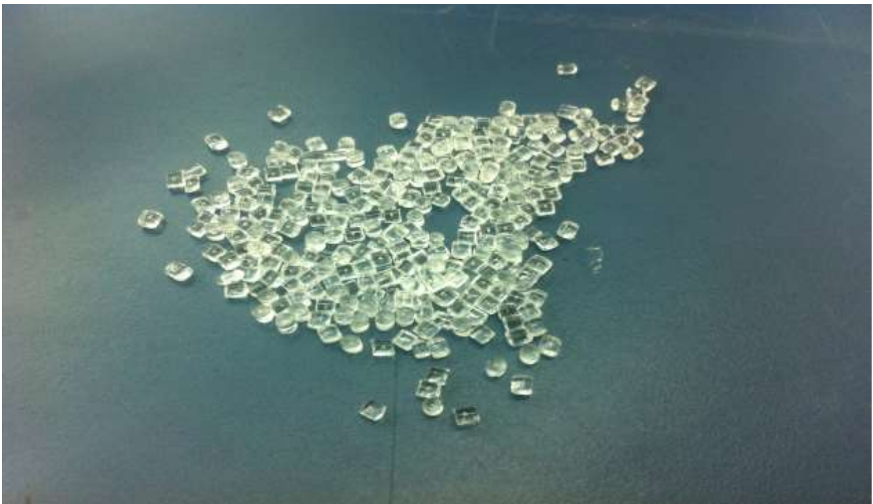
Figura 41. Grilamid Virgem / Foto: Yasser Regis
