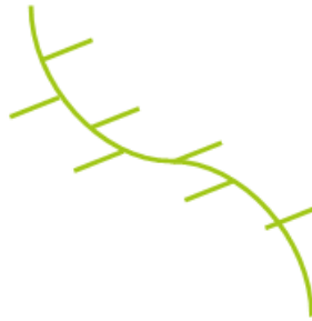
Figura 8: Estrutura Polimérica com Arquitetura de Pente
