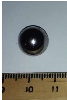
Figura 4.7: Esfera de aço utilizada como parâmetro no processo de validação dos sistema
