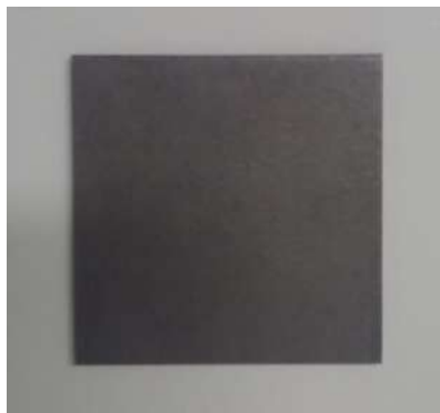
Figura 5.3: Placa de tungstênio utilizada na determinação da MTF
