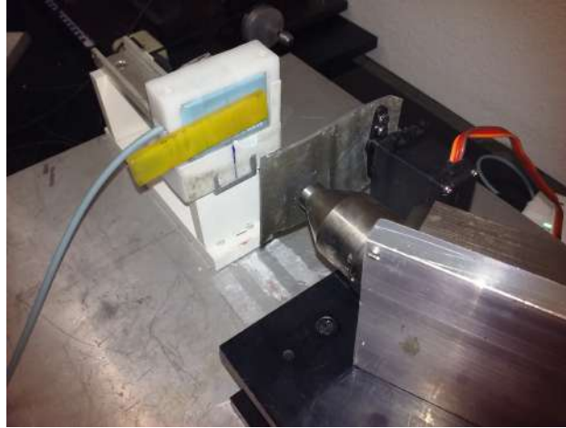
Figura 4.12: Sistema de controle do tempo de exposição do detector à radiação
