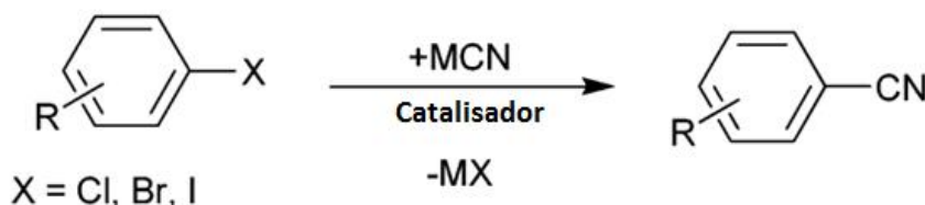
Esquema 6: Nitrilação catalisada por metais de transição.
