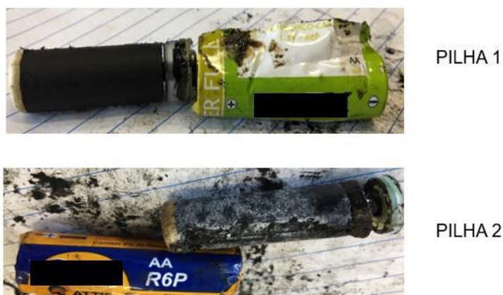
Figura 5. Pilhas 1 e 2 após desmonte.
