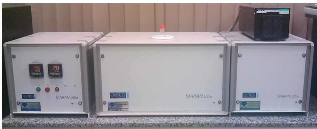
Figura 13. RMN de bancada a ser utilizada neste trabalho.
