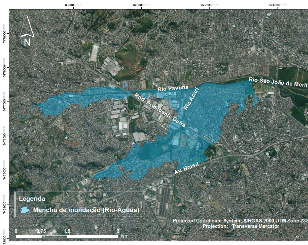
Figura 6.18 - Mancha de inundação elaborada pela Fundação Rio-Águas para o evento de 11 de dezembro de 2013. Elaborado por: LHC – COPPE/UF RJ.
