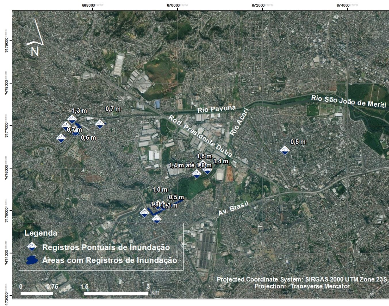
Figura 6.35 – Espacialização dos registros de inundação obtidos através de canais de informação no âmbito do evento do dia 11/12/2013 e lâminas de inundação estimadas. Elaborado por: LHC – COPPE/UFRJ.
