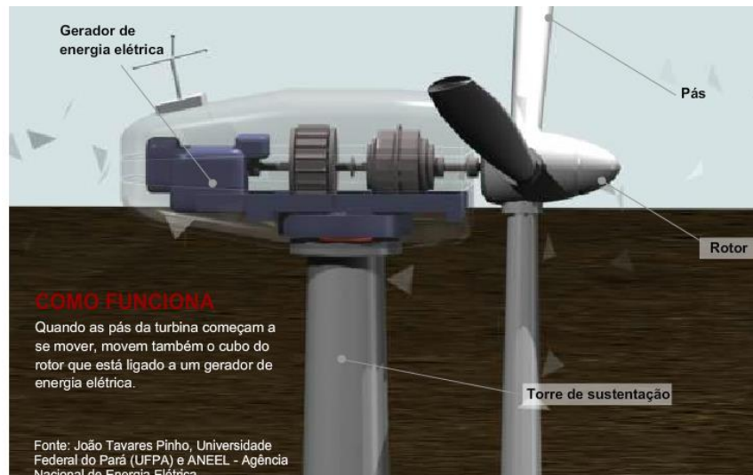
Figura 2.5 : Esquematização de uma nacelle (SANTANA, 2009).
