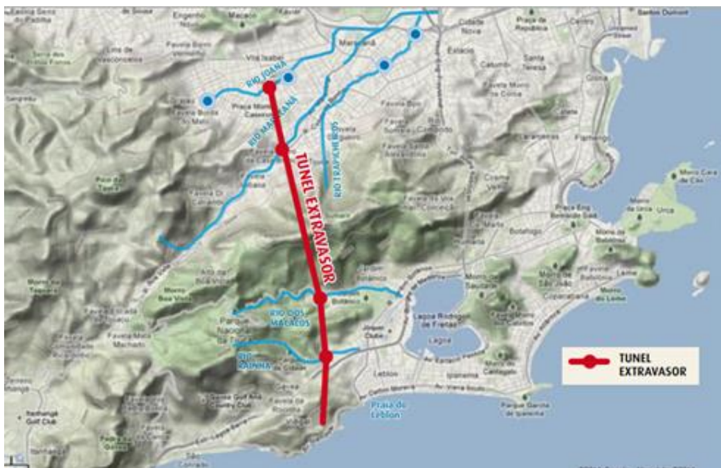
Figura 4.20 – Traçado do Túnel Extravasador. (Clube de Engenharia, 2011)
