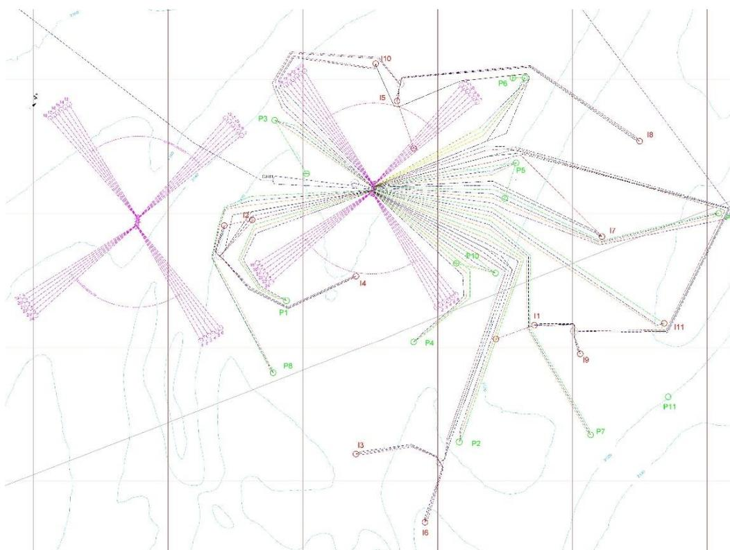
*Figura 59 - Posicionamento de plataforma considerando poços direcionais.*
