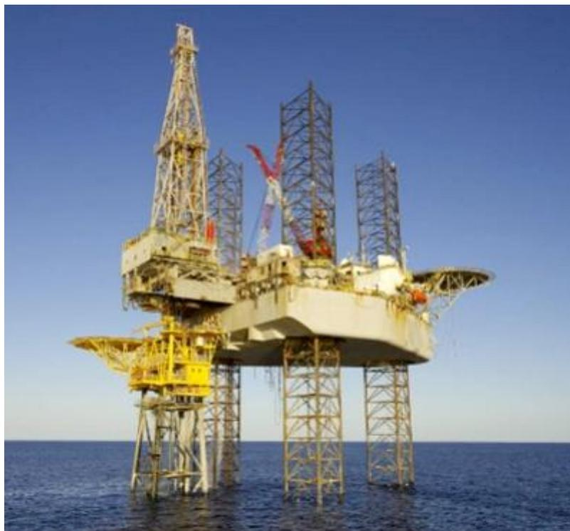
*Figura 10 – Plataforma auto elevatória*
