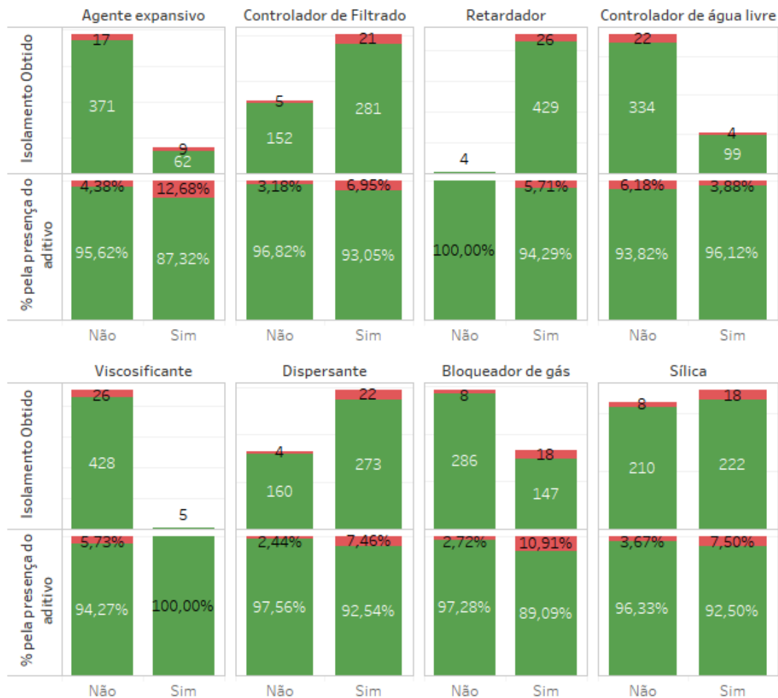
Figura 31 – Análise da qualidade da cimentação por presença de aditivo químico na pasta de cimento
