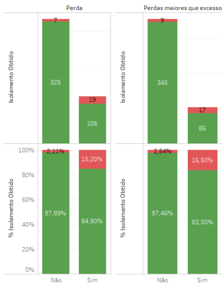
Figura 35 - Relação entre perda de circulação, volume de excesso de pasta bombeado e a obtenção de isolamento hidráulico em BDI
