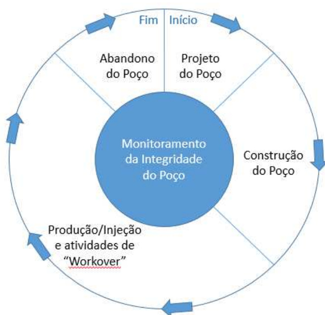
Figura 8 - Fases de monitoramento da integridade do poço (Traduzido de [3])
