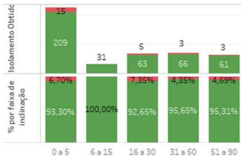
Figura 32 – Análise da qualidade da cimentação por faixa de inclinação do poço
