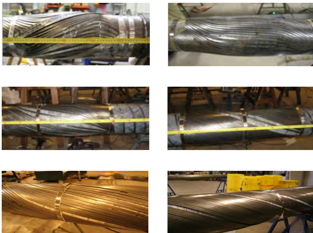
Figura I-7 – Diferentes modos de flambagem lateral obtidos nos ensaios de Østergaard (2012).
