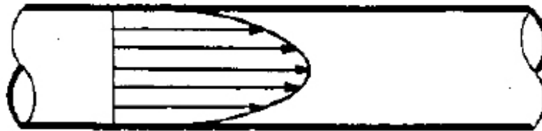
Figura 3.2 - Escoamento laminar – distribuição de velocidade na seção transversal de um tubo [2]
