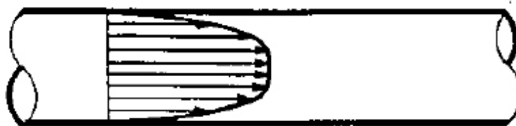
Figura 3.3 - Escoamento turbulento – distribuição de velocidade na seção transversal de um tubo [2]
