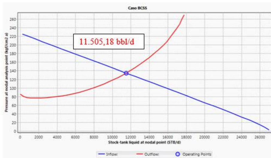
Figura 6.3: Análise nodal realizada no Pipesim para cálculo da vazão – projeto com BCSS
