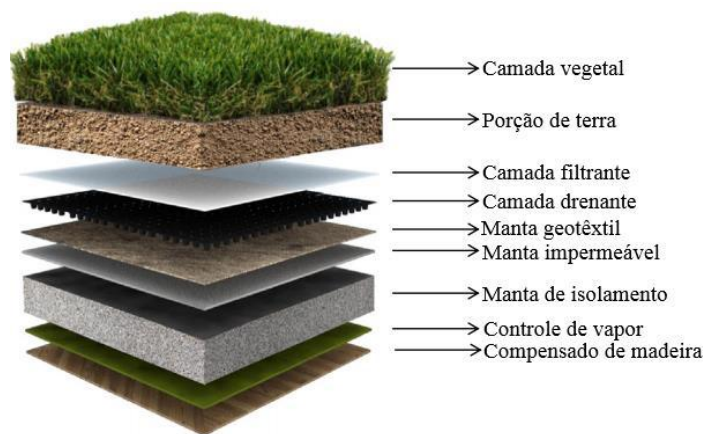
Figura 2.3 - Esquema do telhado verde. Fonte: VIJAYARAGHAVAN (2016) (Tradução própria).
