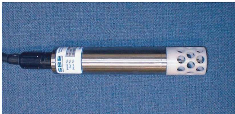
Figura 2.10: Sensor de Temperatura de Superfície do Mar(TSM) Seabird SBE38
