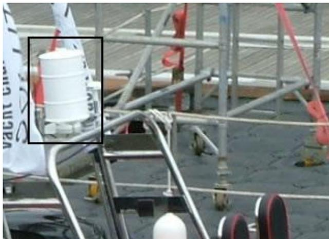
Figura 2.5: Refletor de radar Echomax 230BR
