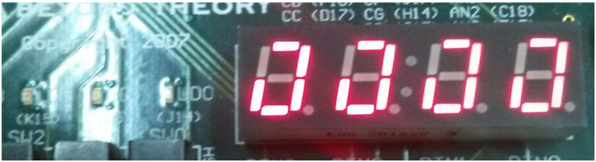
Figura 3.15 - Display e LD0: saída; LD1: flag de cheio; LD2: flag de vazio
