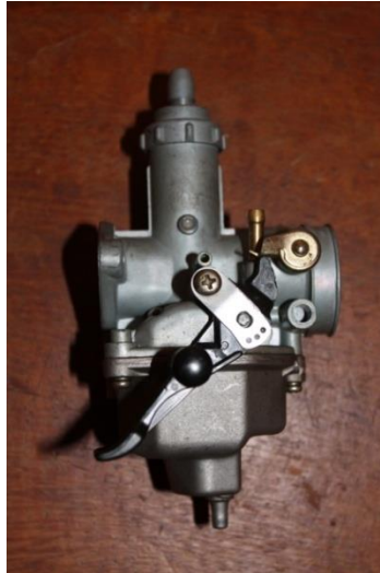
Figura 3.3 – Vista lateral do carburador de corpo simples
