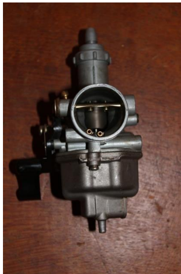
Figura 3.4 – Vista frontal do carburador de corpo simples
