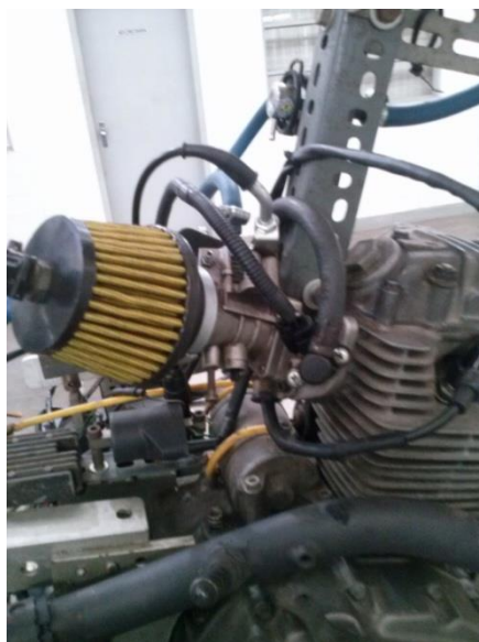
Figura 3.15 – Corpo de injeção já adaptado no motor
