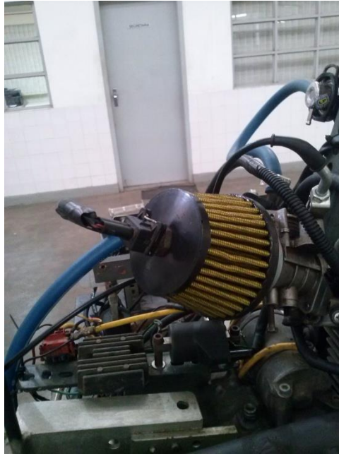
Figura 3.8 – Sensor de temperatura de ar MTE-5061
