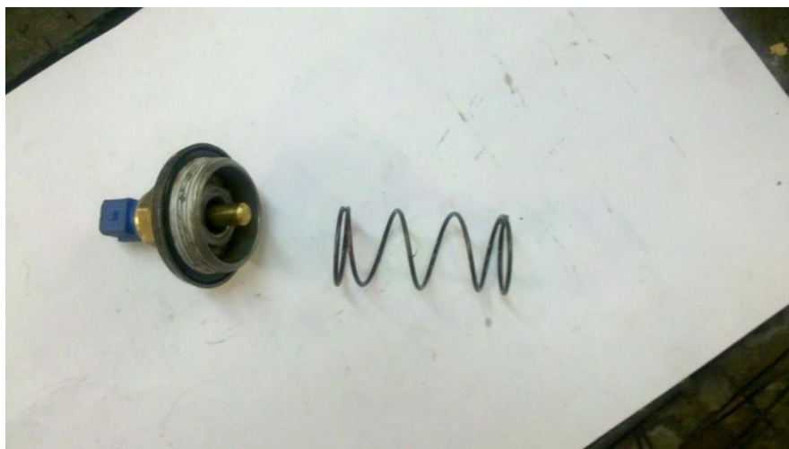
Figura 3.7 – Sequência de montagem do sensor MTE-4053
