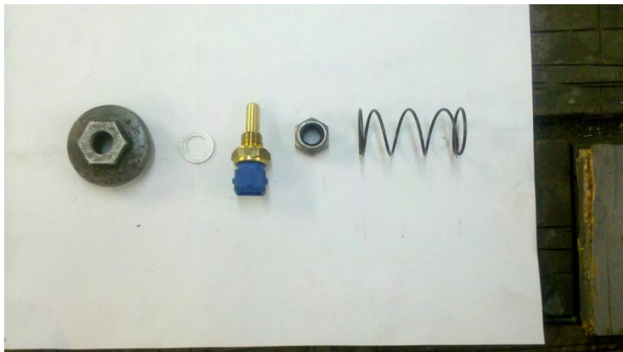
Figura 3.6 – Sequência de montagem do sensor MTE-4053
