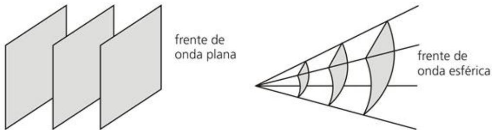
*Figura 2-3 - Frentes de propagação de onda*
