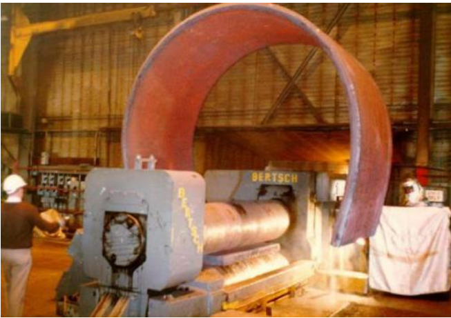
Figura 3.50 – Calandra (retirada de [13])
