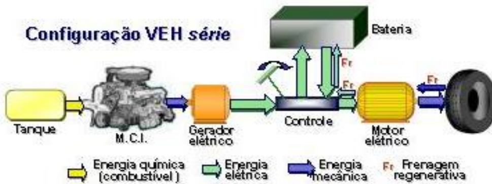
Figura 7 – Plataforma Veicular de Híbridos Elétricos em Série [13]
