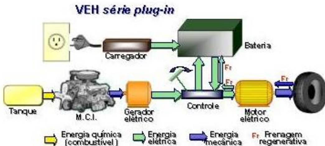
Figura 10 – Plataforma de um veículo elétrico plug-in em série [17]
