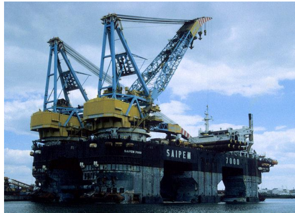
Figura 25 - Plataforma tipo semissubmersível de instalação de plataformas
