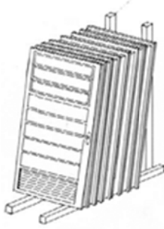
Figura 19 - Exemplo de estocagem de esquadrias - fonte: SGQ - Empresa Rio Verde Engenharia e Construções LTDA.
