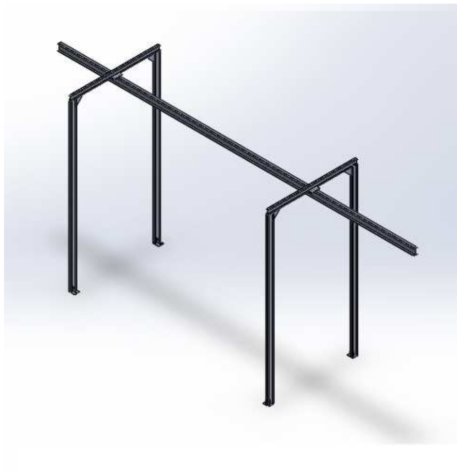
Figura 6.29 – Estrutura de suporte da talha elétrica.
