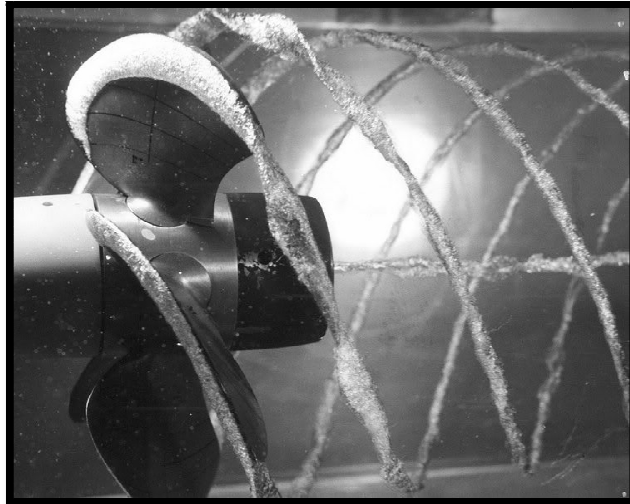
Figura 26 – Cavitação no bordo de ataque [21]
