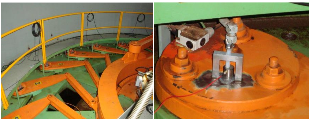
Figura 42 – Foto dos sensores de emissão acústica nas palhetas do distribuidor (à esquerda) [22]
