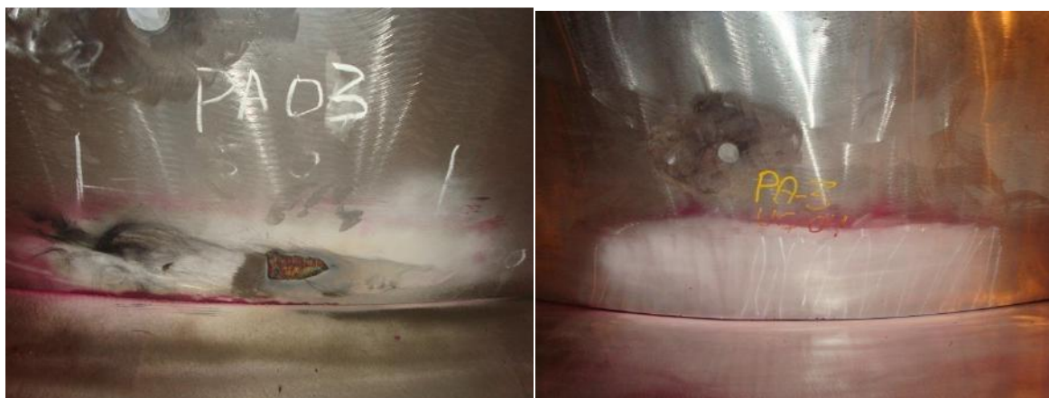
Figura 38 – Erosão na pá da turbina (à esquerda) [22]
