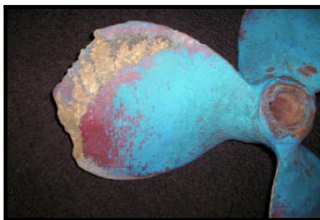
Figura 18 – Erosão no bordo de ataque das pás, provocada por cavitação [17]
