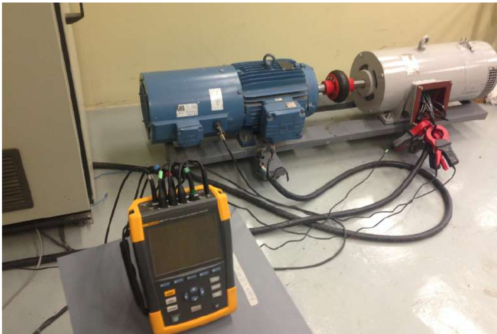
Figura 4.2: Conjunto conversor-motor emulador de uma turbina eólica que aciona o gerador de indução duplamente alimentado (máquina cinza).
