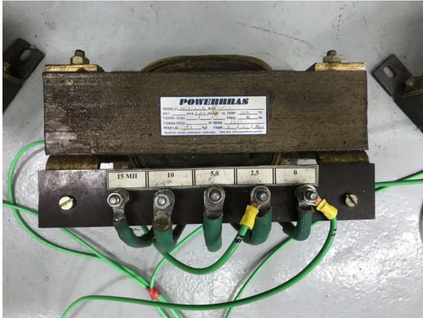
Figura 7.10: Indutor das fases b e c conectado entre o ponto de acoplamento do sistema e a rede local para a obtenção de perfil de tensão desequilibrado.
