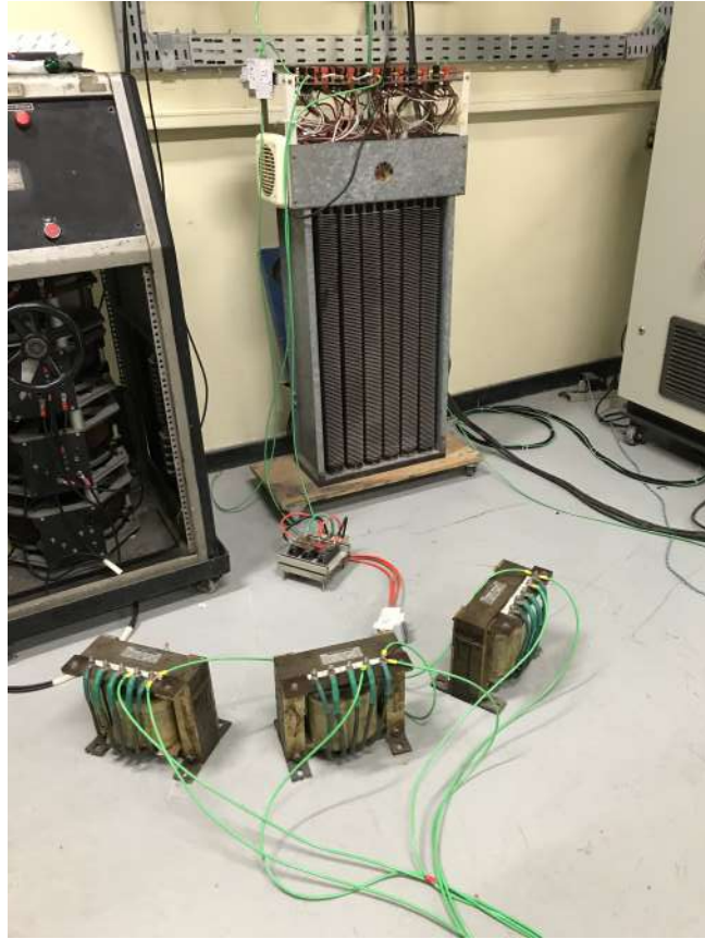
Figura 7.7: Montagem para a obtenção de tensão distorcida no ponto de acoplamento do sistema.
