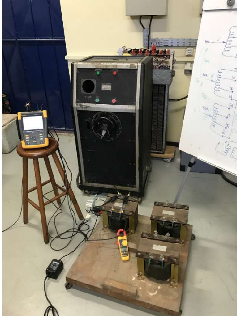
Figura 4.6: Organização para o desenvolvimento dos ensaios clássicos de transformadores.
