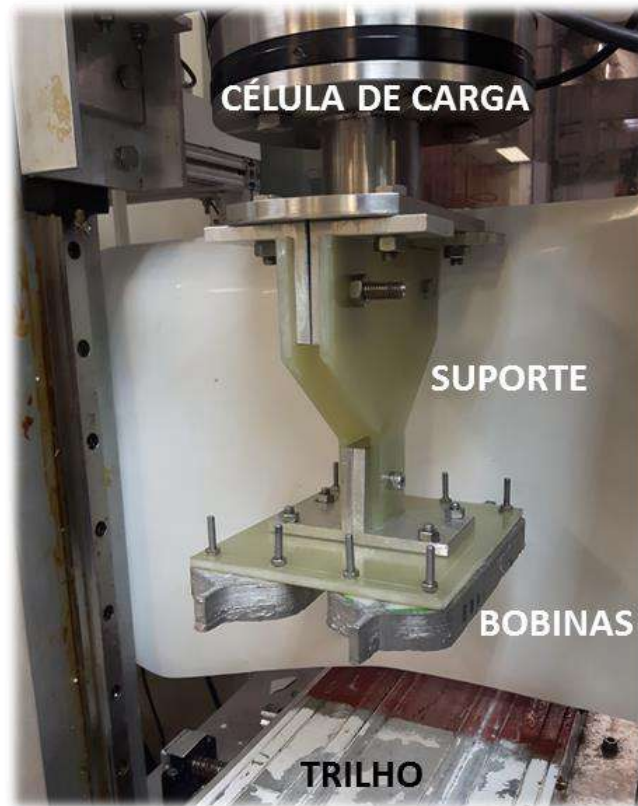
Figura 5.24. Posicionamento das bobinas em relação ao trilho de ímãs permanentes para os testes de força números 2 a 14.
