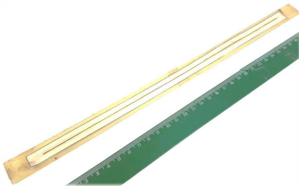
Figura A.1. Gabarito de corte em G10 de 0,5 mm de espessura.
